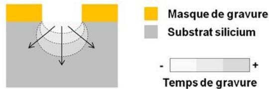
Figure 2.5 – Vue schématique d'un échantillon en coupe : profil de sous-gravure de la cavité en fonction du temps de gravure
