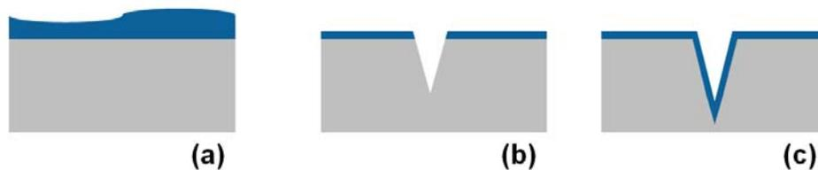
*Figure 3.1 – Morphologie de dépôts sur des échantillons en vue transversale
