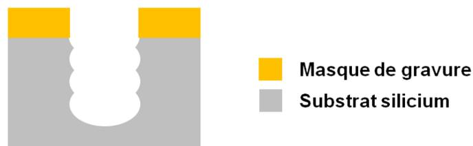
Figure 2.13 – Vue en coupe du profil de gravure d’un échantillon : phénomène de festonnage
