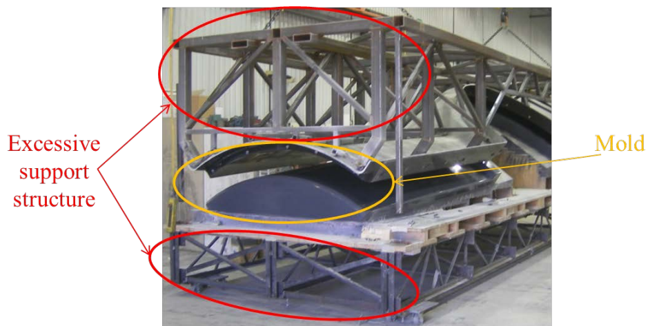
Figure 11 Photographie d'un moule industriel avec des supports [30]
