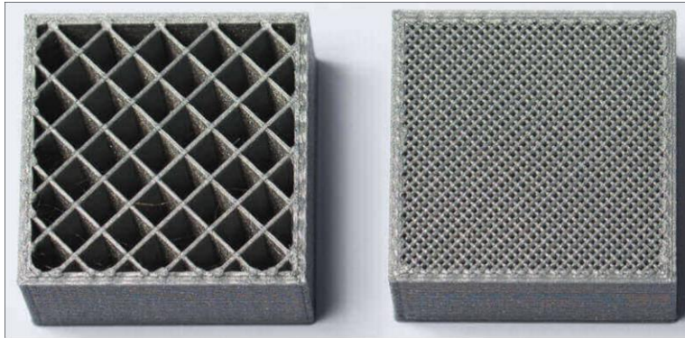
Figure 5.8 : Image d'un objet-test imprimé par impression 3D avec un remplissage de 20 et 50 %. Image extraite de www.3dhubs.com
