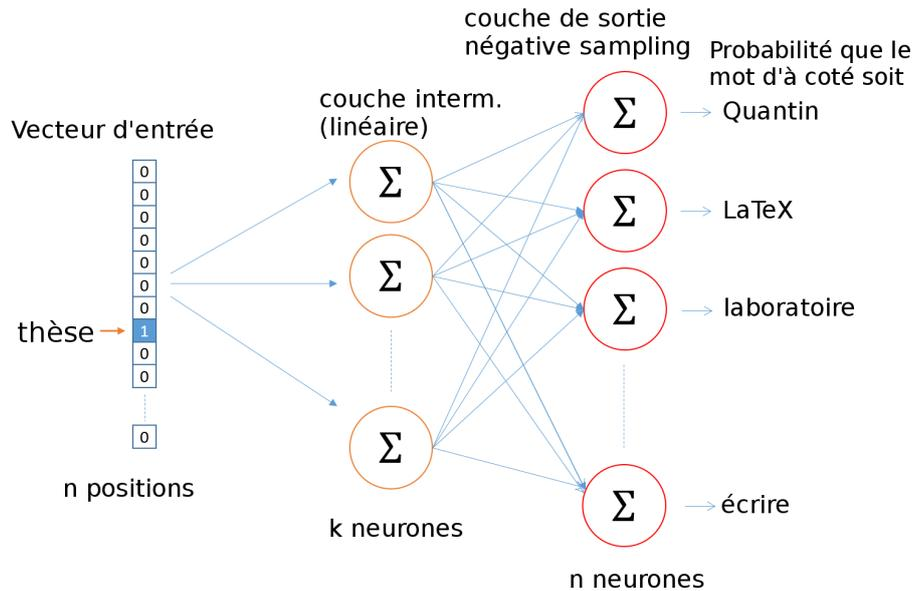
FIGURE 1.27 – Représentation du réseau de neurones par Chris McCormick. En entrée un vecteur de 0 pour chaque lemme du corpus ( $n$ ) sauf pour une position, en sortie la probabilité d’obtenir un des  $n$  lemmes dans la fenêtre du mot d’entrée.
