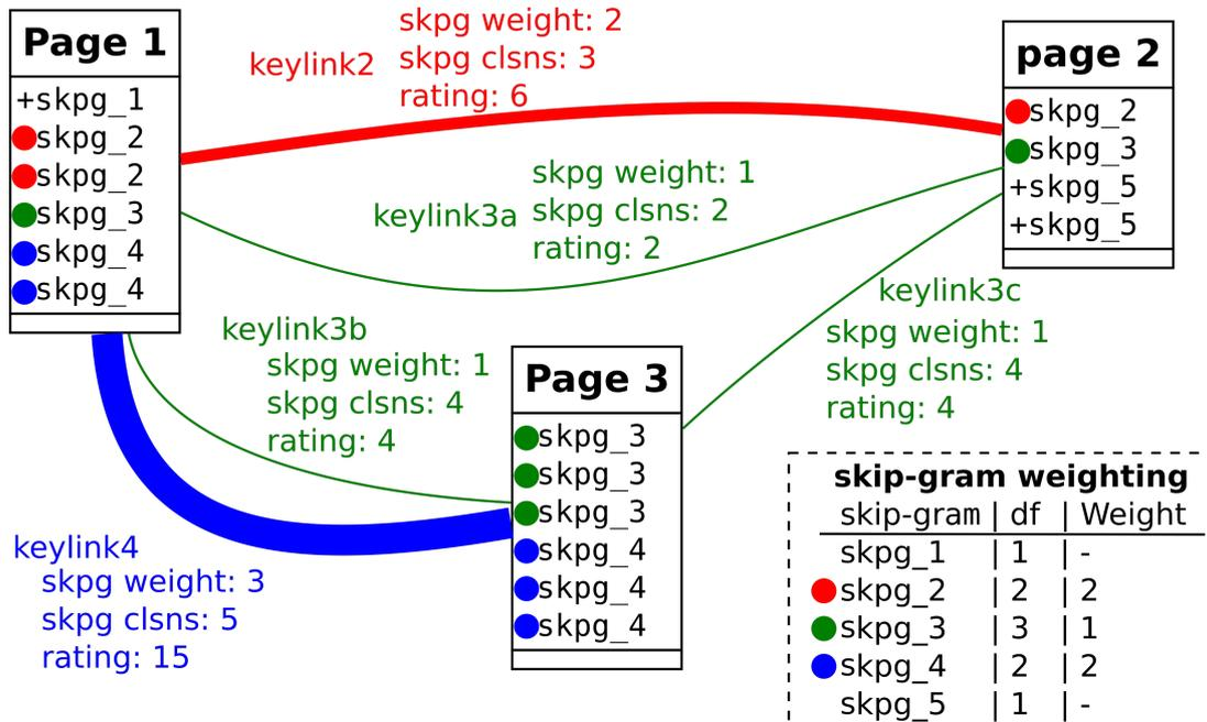
FIGURE 2.14 – Schéma simplifié de la création de *lien-clé*. *Weight* indique le poids d'un skip-gram. *Clsns* indique le volume commun à 2 *pages* ; *rating* la pondération du lien, proportionnelle à l'épaisseur du trait.
