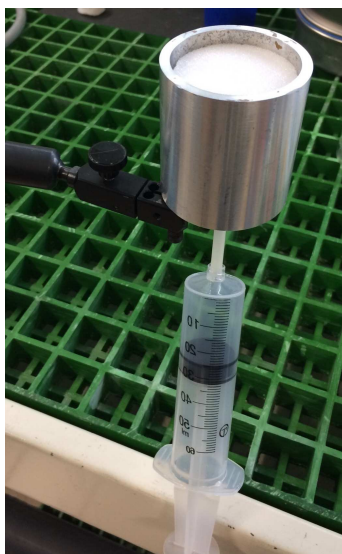
Figure 2.10 – Imprégnation par capillarité forcée.
