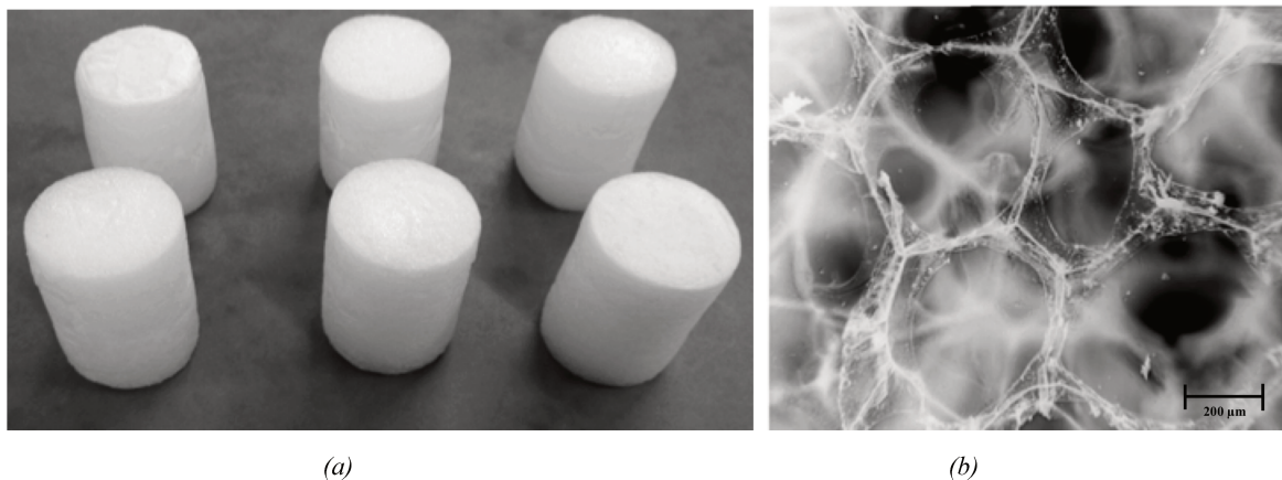
Figure 2.14 - Echantillons de cellulose à l’échelle macroscopique (a) et microscopique (b).
