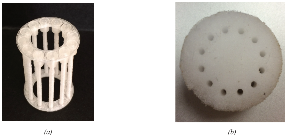
Figure 4.29 - Structure du réseau méso-poreux (a) / Mousse de cellulose à double porosité obtenue (b).
