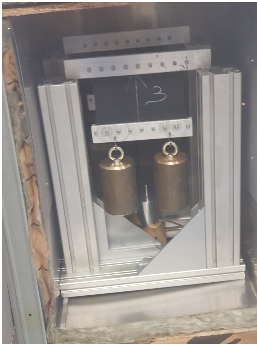
Figure 2.53 – Essai de vieillissement thermique de plaques sous contraintes mécaniques de cisaillement
