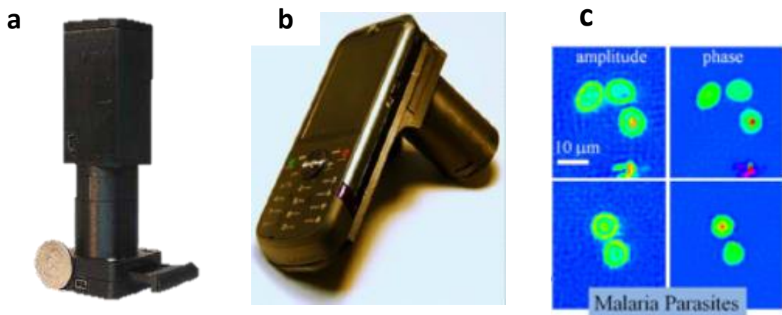
Figure 57 : L'appareillage LUCAS. a) microscope holographique à super-résolution de pixels « Lensfree » ; b) téléphone couplé au microscope Lensfree ; c) signature en image du parasite de la malaria dans des globules rouge. Source : « Accelerating commercialization of cost-saving health technologies » de Booz|Allen|Hamilton et California Healthcare Foundation (mai 2012).
