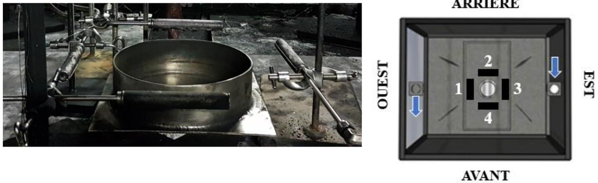
Figure 31 : Vue latérale et schéma, en vue de dessus, de la position des analyseurs de gaz autour du foyer.
