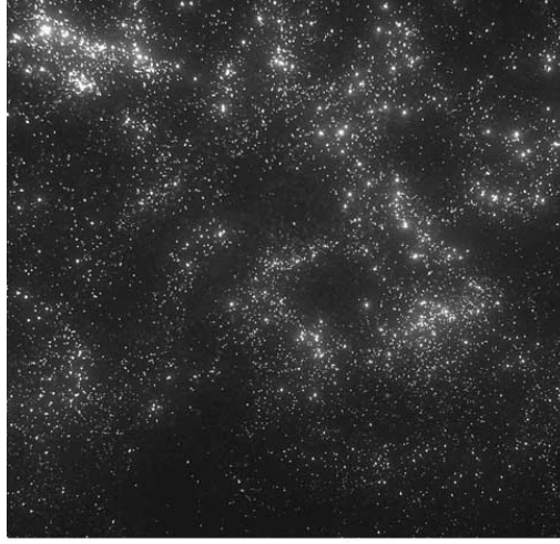
FIGURE 1.15 – Nappe laser éclairant un écoulement homogène turbulentensemencé par des particules, illustrant la concentration préférentielle. Wood et al. (2005).
