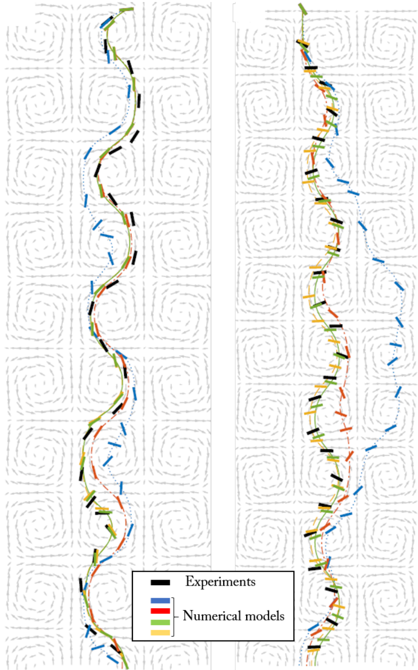
FIGURE 1.14 – Trajectoires expérimentales (—) et trajectoires obtenues en utilisant les différents modèles numériques : slender-body (---), correction sur le rapport d'aspect (---), correction à faible inertie (---), correction générale sur l'inertie (---). (À gauche) Re_k = 2 , Re_{fibre} \approx 0.1 . (À droite) Re_k = 25 et Re_{fibre} \approx 2 . Lopez and Guazzelli (2017) .
