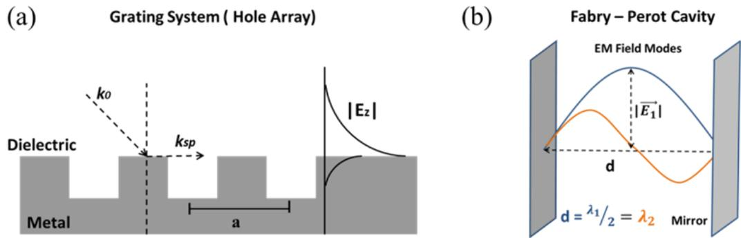
**Figure 2.** (a) Représentation schématique du couplage d'un système de réseau avec une périodicité  $a$ , indiquant la direction du vecteur  $k_{sp}$  du moment du plasmon de surface. Le champ électrique évanescent ( $E_z$ ) à l'interface métal-diélectrique est représenté par la ligne noire sur le côté droit de la figure. (b) Exemple schématique de l'amplitude des premier et deuxième modes de cavité Fabry-Pérot (FP) confinés entre deux miroirs métalliques parallèles.
