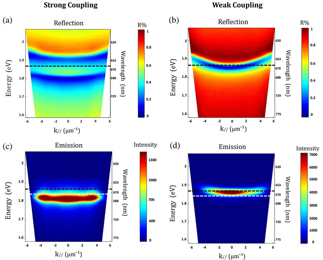
**Figure 4.** Spectres dispersifs de réflexion (a) à haute concentration (régime de couplage fort) et (b) à faible concentration (couplage faible) pour des cavités remplies de solution Ce6 / DMF résonnant avec l'énergie de transition du Ce6 (lignes pointillées). Les courbes de dispersion d'émission provenant des mêmes cavités sont indiquées en (c) et (d).
