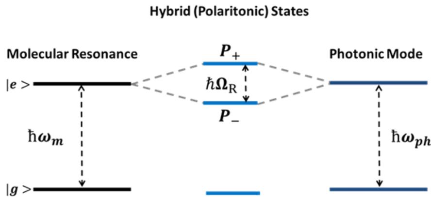
**Figure 1.** (a) Représentation schématique du couplage fort d'une transition moléculaire d'énergie  $\hbar\omega_m$  et d'une résonance optique d'énergie  $\hbar\omega_{ph}$  formant les états hybrides  $P_+$  et  $P_-$  séparés par l'énergie de séparation de Rabi  $\hbar\Omega_R$ .
