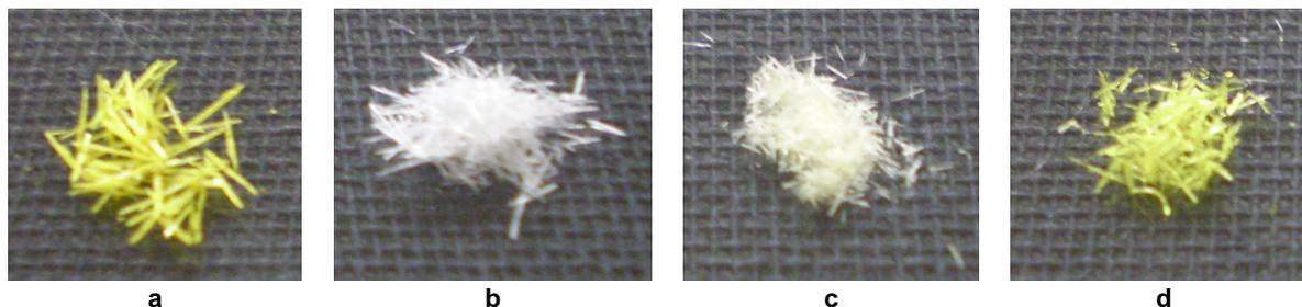
*Photo 10 : Cristaux  $3_3-[\text{Fe}(\text{CN})_6]_2$  (a),  $3_3-[\text{Co}(\text{CN})_6]_2$  (b),  $3_3-[\text{Cr}(\text{CN})_6]_2$  (c) et solution-solide  $3_3-[\text{Fe}_{1/3}\text{Co}_{1/3}\text{Cr}_{1/3}(\text{CN})_6]_2$  (d).*
