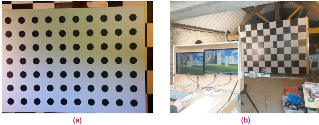
**FIGURE 3.7** – (a) Photographie de la mire Zhang, acquise durant la procédure de calibration. La mire est adaptée pour qu'elle soit manipulée par une personne. (b) Image du processus de calibration suivant la méthode de Tsai. Les dimensions de la mire ( $3,05 \times 2,44\text{m}$ ) font que la distance entre les caméras et la cible est sensiblement la même que lors des acquisitions dans le tunnel.
