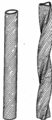
Figure 1.6: Torsion des parois cellulaires d'une fibre naturelle lors d'un essai de traction [27]
