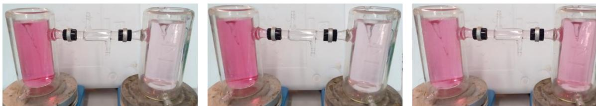
Figure 95. Photographies illustrant l'homogénéisation des espèces en solution au sein du réacteur en H. De gauche à droite,  $t=0$ ,  $t=1h$  et  $t=8h$ , (expérience C1).
