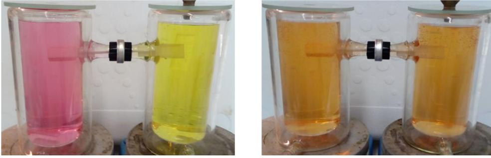
Figure 100. Photographies illustrant l'homogénéisation des espèces en solution au sein du réacteur avec le système de contre-pales. A gauche à  $t=0$  minutes, à droite à  $t= 30$  minutes
