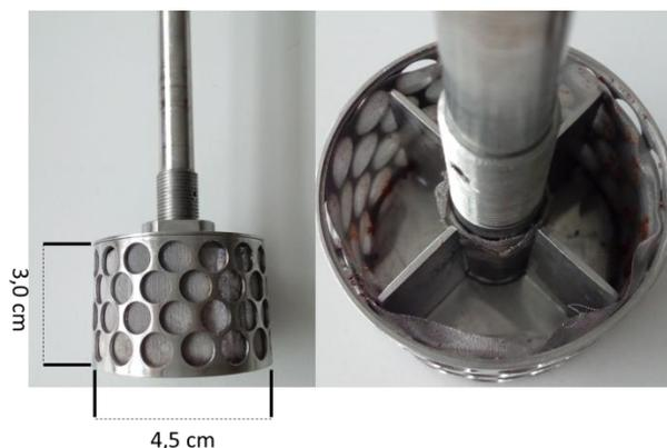
Figure 44. Illustration et dimensions du panier d'agitation.
