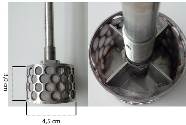
Figure 89. Illustration et dimensions du panier d'agitation.
