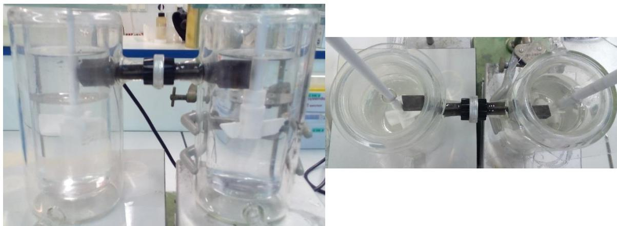
Figure 102. Photographie du réacteur en H comportant le système de contre-pâles pour l'étude de transport du fructose. Vue de face et vue du dessus.
