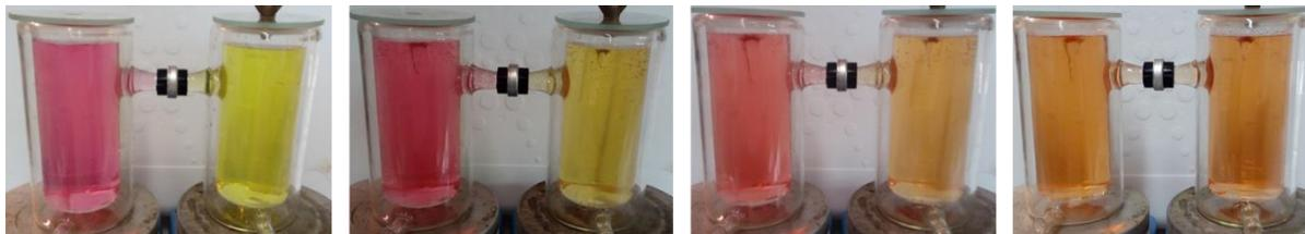
Figure 97. Illustration de l'homogénéisation des espèces en solutions dans les deux compartiments. De gauche à droite  $t=0$  minutes,  $t=1\text{h}$ ,  $t=3\text{h}$  et  $t=8\text{h}$ .
