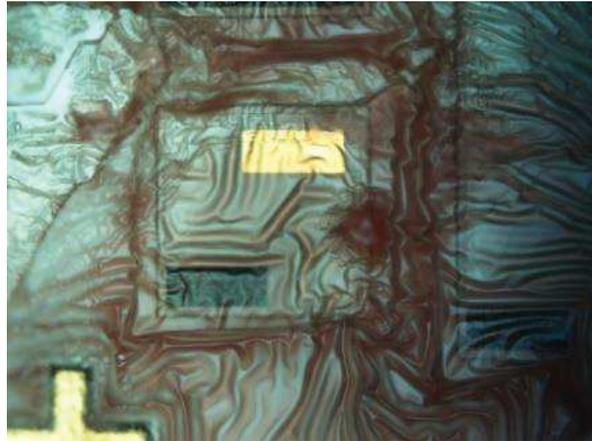
*Figure II-20: Etat de surface de l'échantillon en fin de procédé de transfert en utilisant la résine AZ 4562*
