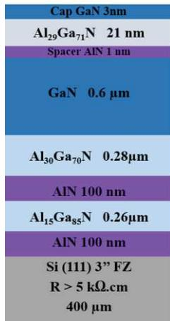
Figure II-2: Descriptif structural de l'échantillon PTC 756
