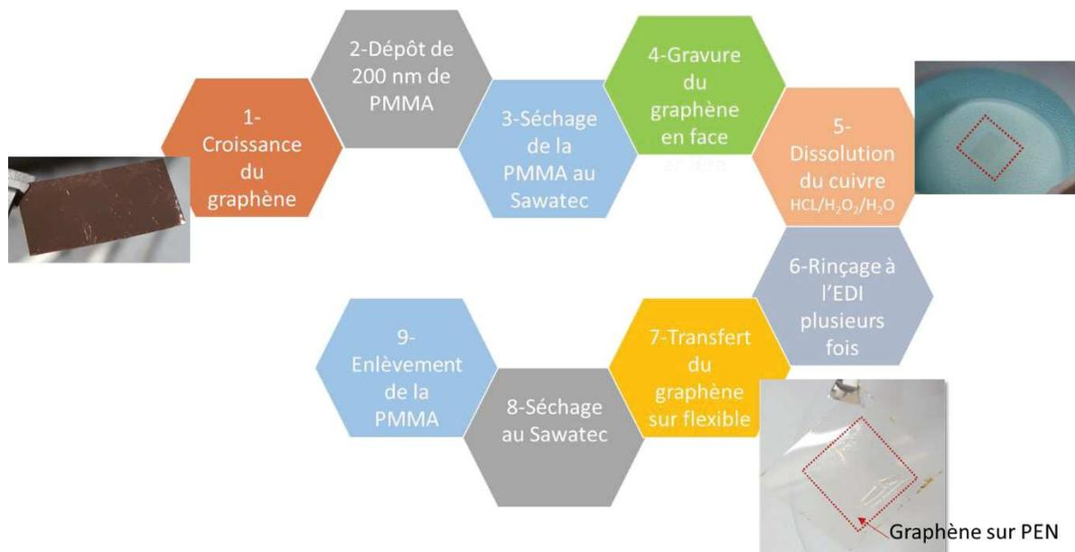
Figure II-37: Etapes du procédé de transfert du graphène sur substrat flexible
