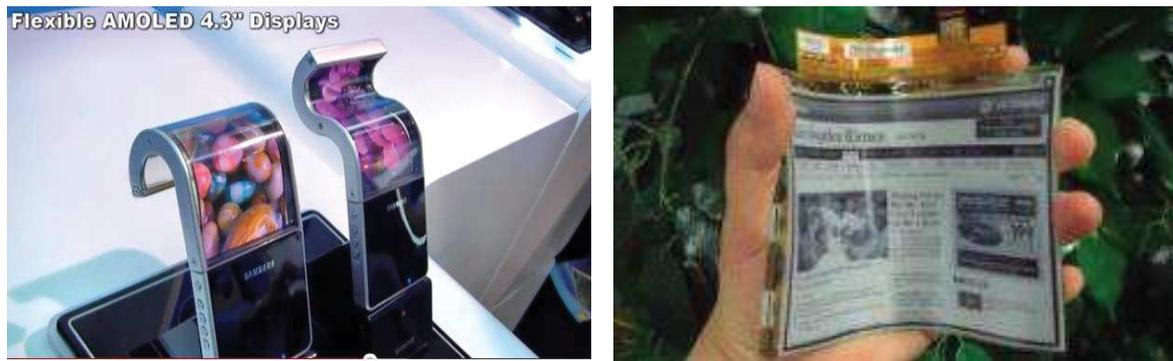
Figure I-2: Illustration de (a) Dispositifs d'affichage flexible de Samsung [7] (b) Papier électronique de LG [8]
