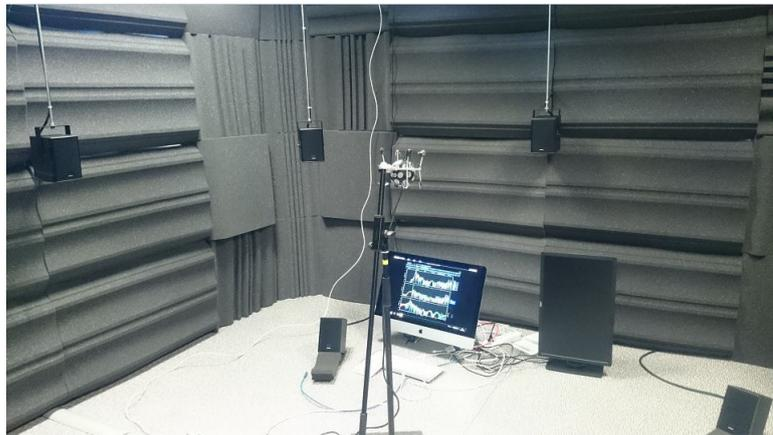
FIGURE B.1. – Salle munie de panneaux absorbants.
