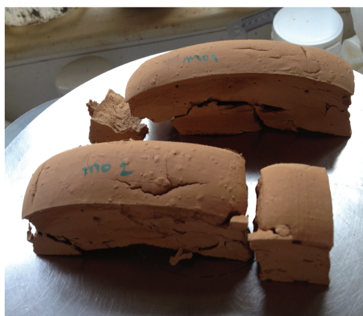
FIGURE 3-48 – Éprouvettes de FAC + amidon D' fissurées et déformées.
