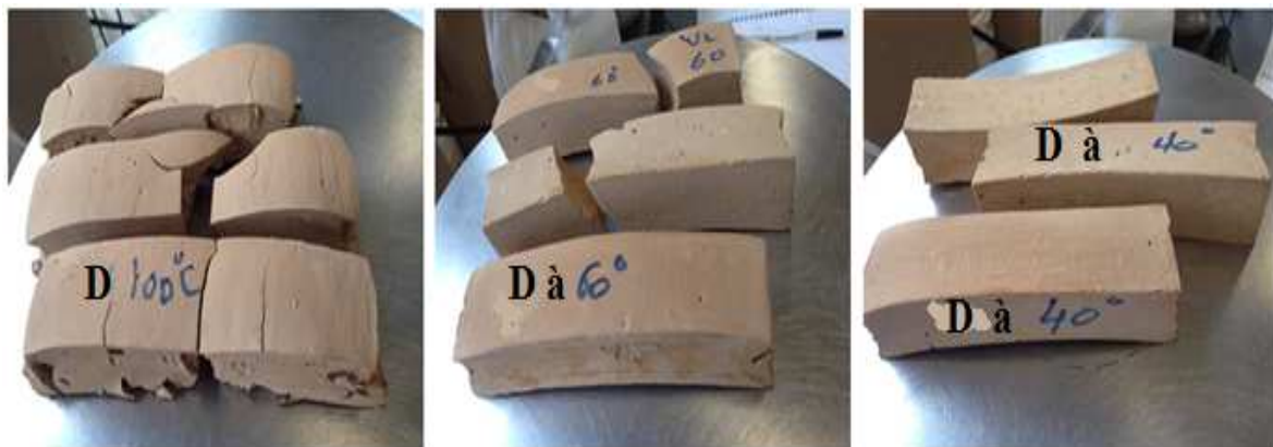
FIGURE 3-20 – Éprouvettes de FAC + amidon D conservées à 40, 60 et 100°C.
