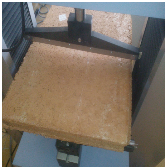
FIGURE 4-50 – Essai de flexion sur un carreau de 65 \times 50 \times 7 \text{ cm}^3 .
