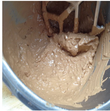
FIGURE 3-1 – Mélange de FAC + amidon en fin de malaxage.
