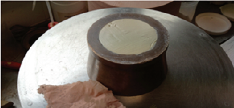
FIGURE 3-40 – Les étapes d’essai d’étalement de mélange de kaolinite + amidon.
