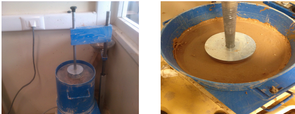
FIGURE 4-5 – L'essai au consistomètre VEBE.
