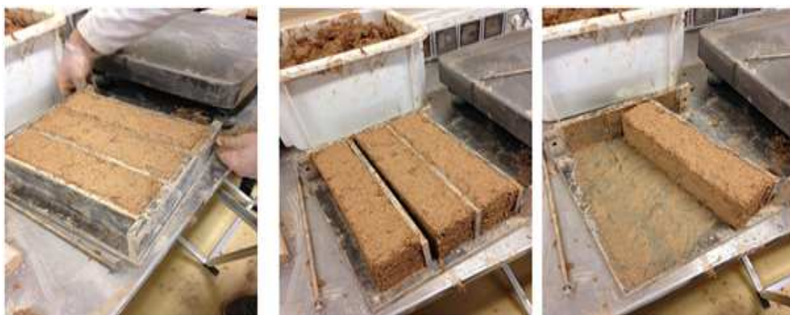
FIGURE 4-20 – Démoulage des éprouvettes prismatiques.
