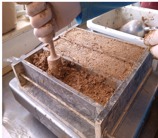
FIGURE 4-19 – Mise en place de la matière dans le moule.
