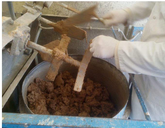
FIGURE 4-1 – Un mélange à base de terre crue et de chènevotte dans le malaxeur.
