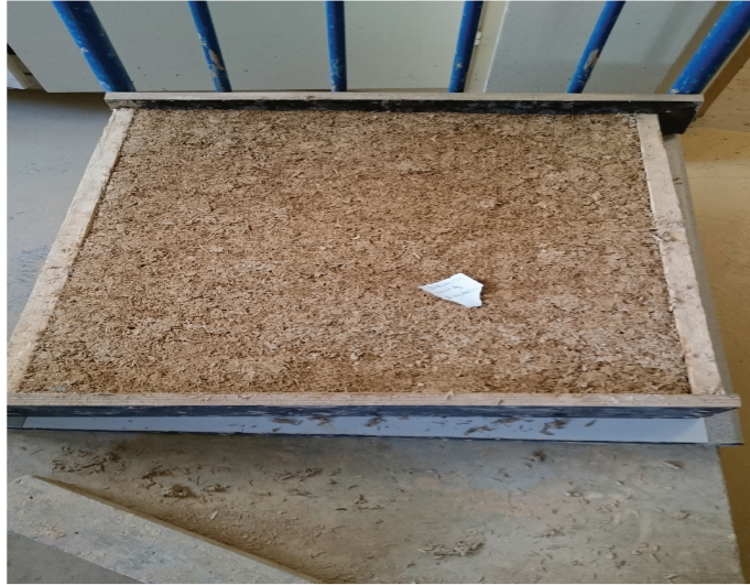
FIGURE 4-42 – Exemple de carreau après moulage.
