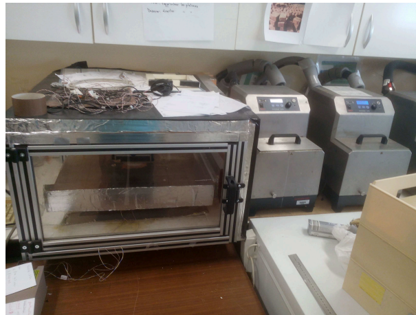
FIGURE 4-57 – Le dispositif plaque chaude gardée utilisé pour les essais thermique.
