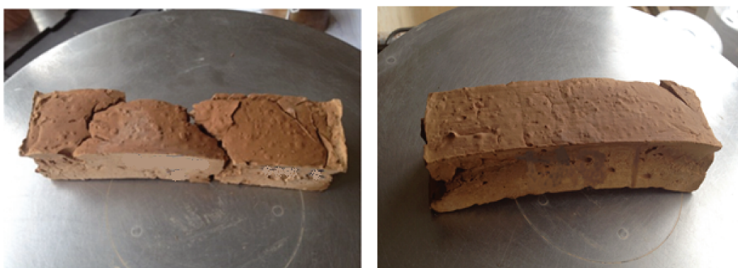
FIGURE 3-15 – Éprouvettes déformées et fissurées de FAC + amidon J (gauche) et de FAC + amidon K (droite).
