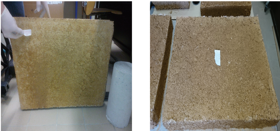
FIGURE 4-43 – Comparaison entre deux carreaux avec \frac{L}{G} = 5,5 (gauche) et \frac{L}{G} = 3,5 (droite).
