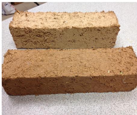
FIGURE 4-23 – Éprouvettes ( 7 \times 7 \times 28 \text{ cm}^3 ) à base de FAC, anas de lin et amidon après fabrication (en bas) et en fin de séchage (en haut).
