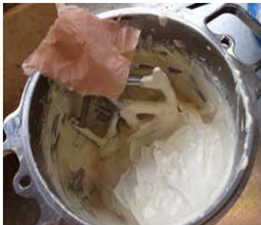
FIGURE 3-39 – Mélange de kaolinite + amidon D en fin de malaxage.
