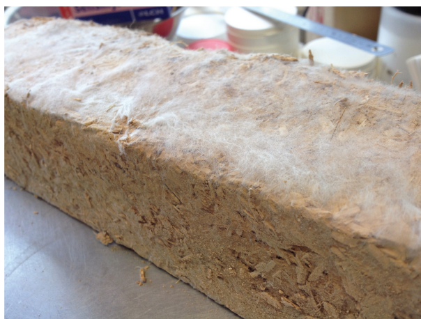
FIGURE 4-24 – Moisissures observées sur une éprouvette à base de FAC, chènevotte et amidon .
