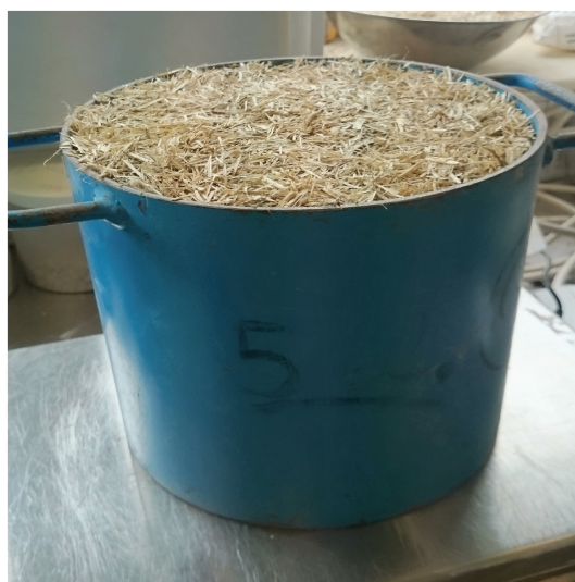
FIGURE 2-15 – Récipient normalisé de 5 litres contenant l'anas de lin.
