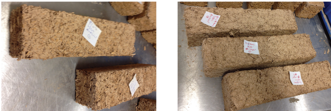
FIGURE 4-38 – Éprouvettes à base de FAC + chènevotte (gauche), et de FAC + anas de lin (droite) avec L/G = 3,5 .
