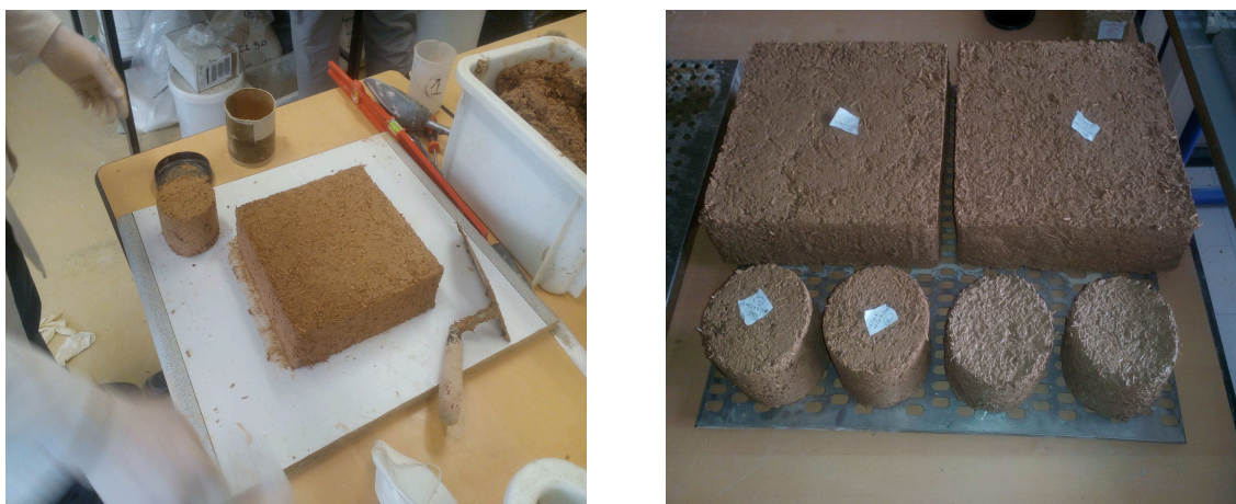
FIGURE 4-56 – Éprouvettes thermiques et acoustiques après fabrication (à gauche) et pendant le stockage (à droite).
