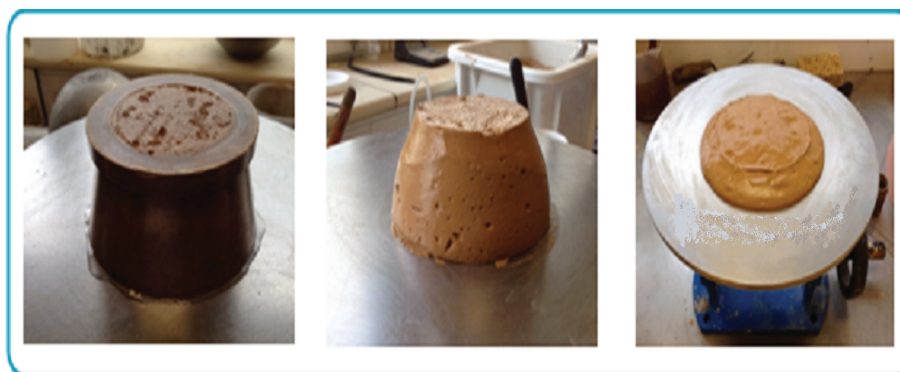
FIGURE 3-4 – Les étapes d'essai d'étalement d'un mélange de FAC + amidon.
