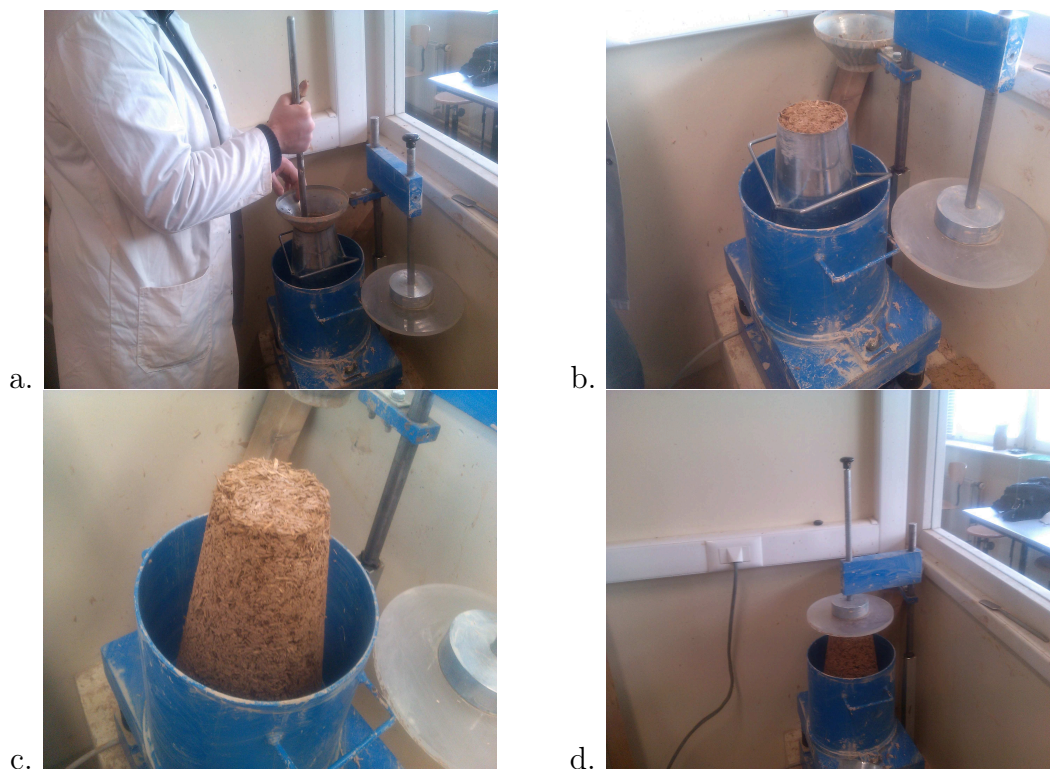
FIGURE 4-4 – Remplissage du moule du consistomètre VEBE.
