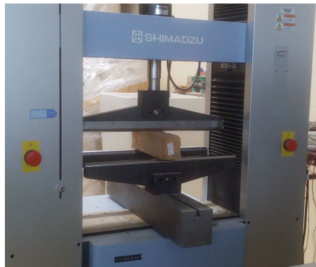
FIGURE 4-6 – Essai de flexion sur une éprouvette ( 7 \times 7 \times 28 \text{ cm}^3 ).
