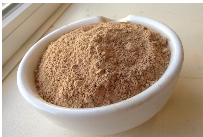
FIGURE 2-2 – Particules de fines argilo-calcaires sous forme de poudre sèche.
