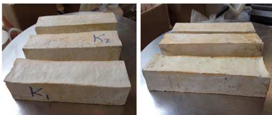
FIGURE 3-43 – Éprouvettes de kaolinite (gauche) et éprouvettes de kaolinite + amidon H (droite).
