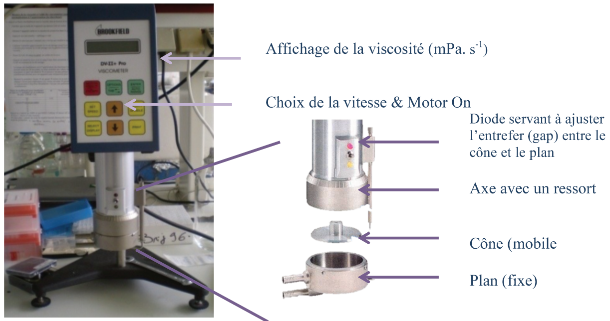
Figure 46. Le principe du viscosimètre cône-plan.
