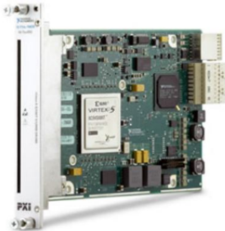
FIGURE I.2 – Photo de la FlexRIO 7966R de l'émetteur
