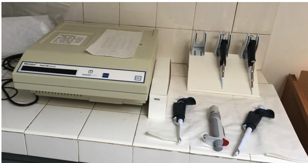
Figure 2.9 : Appareil de mesure Microtox®
