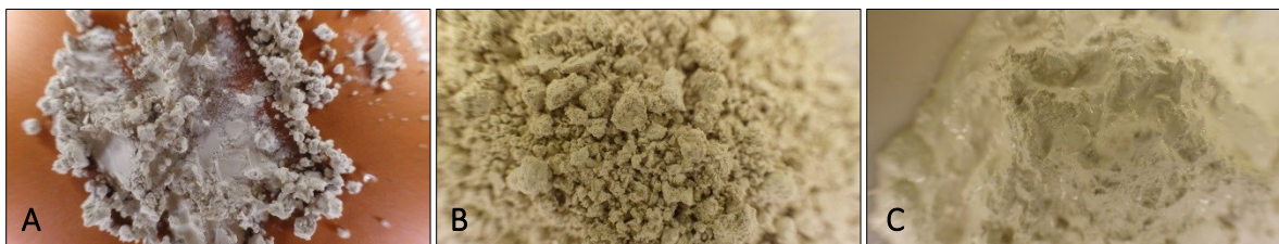
Fig. 22 – Photographies illustratives des textures des mélanges aqueux de pérovskites avec différentes teneurs en pérovskite. (A) La poudre de \text{CaTiO}_3 sèche ; (B) Un mélange de 70% v/v de \text{CaTiO}_3 et eau ; (C) Un mélange de 30% v/v de \text{CaTiO}_3 et eau. Echelle de 2 cm x 1 cm.
