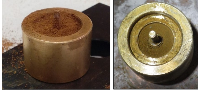
Fig. 62 – Insertion de l'échantillon de Tholins dans le Porte-Echantillon, à l'état non compressé (gauche) ; l'échantillon de Tholins compressé (droite).
