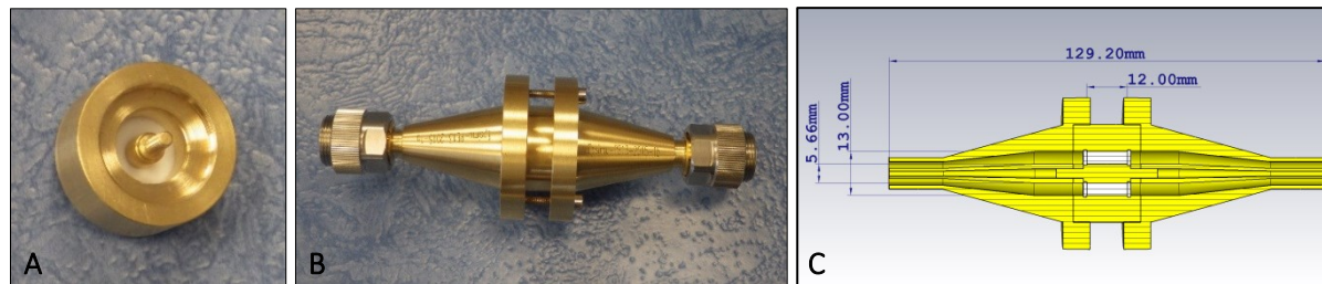
Fig. 3 – A) La zone de confinement « Porte-Echantillon » vide. B) La cellule conique coaxiale complète. C) Détail de l'intérieur de la cellule 13 mm dans l'environnement de simulation CST Microwave Studio.
