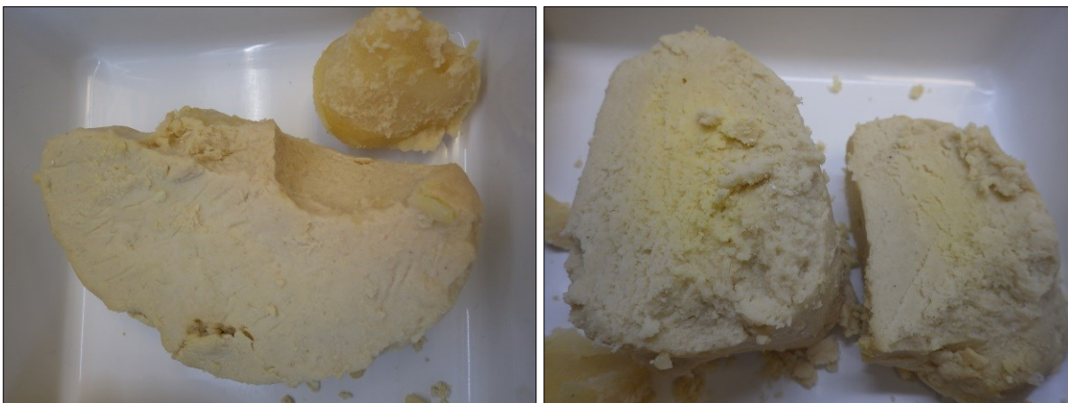
Fig. 20 – L'intérieur du Fantôme II neuf mois après la fabrication. Il est possible de vérifier une altération de la couleur sur les couches les plus extérieures.
