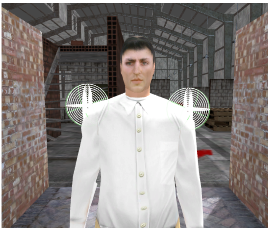
Figure 4.4. – L'enregistrement des mouvements du corps est utilisé pour animer un avatar colocalisé (la tête de l'avatar n'était pas représentée pendant l'expérience). Les centres des sphères sur chaque épaule correspondent à la position des vibreurs sur le sujet. Leur taille représente la zone dans laquelle la détection de proximité avec l'environnement et l'activation des vibreurs était effectuée.
