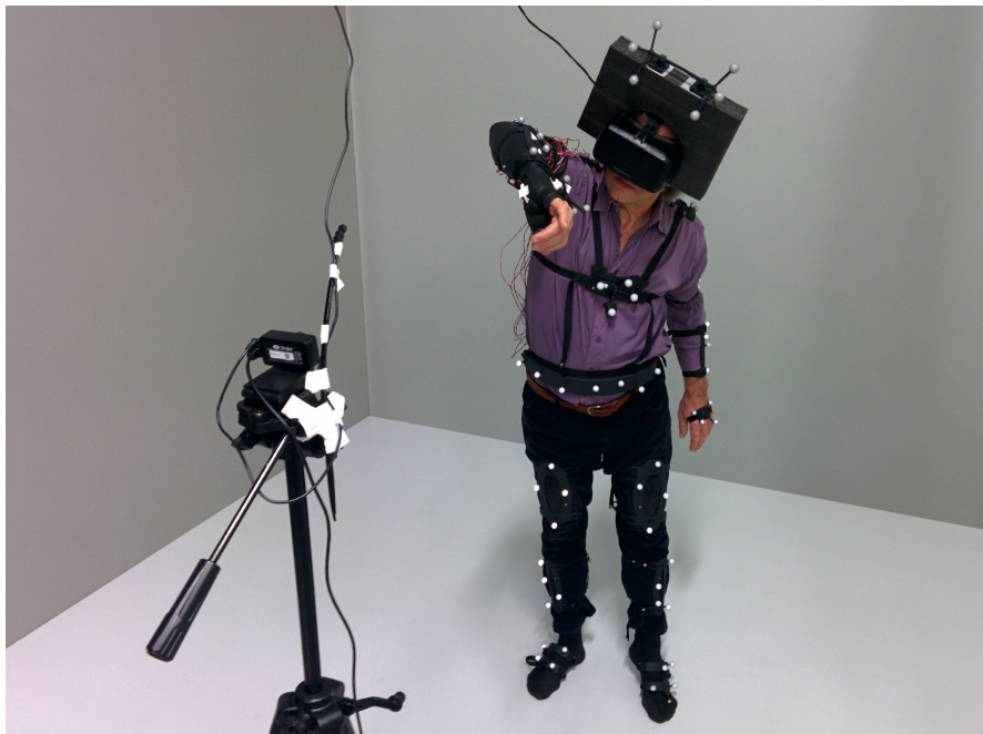
Figure 5.4. – Sujet en situation expérimentale. Il porte un casque immersif avec le capteur infrarouge externe pour la capture de mouvements face à lui. Il est aussi équipé d'une combinaison ART pour la capture de mouvements.
