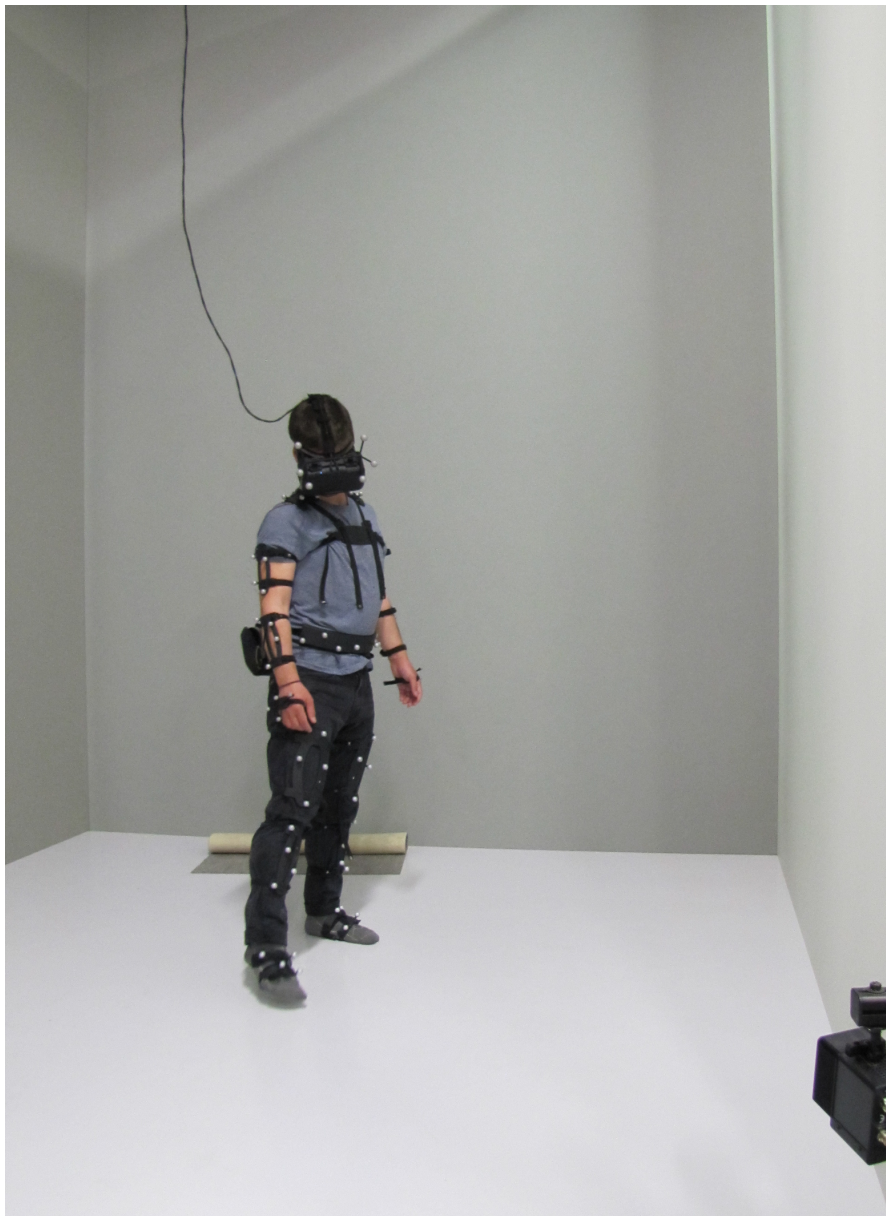
Figure 4.2. – Un sujet dans le dispositif expérimental. Il porte le HMD , équipé d'une constellation ART pour le suivi des mouvements de translation de la tête. Il porte également un ensemble de marqueurs ART pour la capture de l'ensemble des mouvements du corps.
