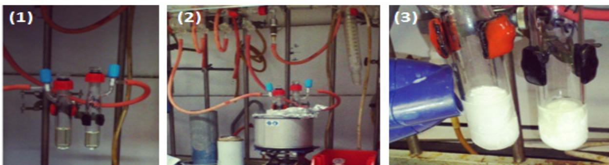
**Figure II. 21: les 3 étapes du « Freeze-pump » appliqué à l'isopropoxyde de titane et à l'acétylacétone.**
