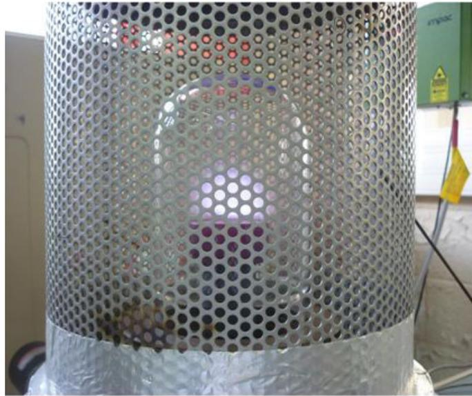
Figure II.24. Photographie du plasma lors de la synthèse de nanotubes par PECVD.
