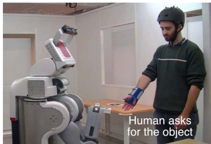
FIGURE 2.17 – Le robot détecte que l'homme demande l'objet en utilisant la distance de la main par rapport à son corps, grâce au module de suivi d'agent de TOASTER, pour comprendre que l'homme est en train de tendre le bras. Ici, un système de capture de mouvement est utilisé pour suivre les positions de la tête et du bras de l'homme.
