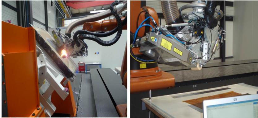
FIGURE 2.6 – Machine de placement de fils pré-impregnés développée par Coriolis Composites [Barasinski, 2012]
