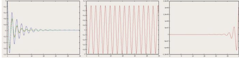
FIGURE A.1 – Méthode d'Euler explicite – Le graphique de gauche montre plusieurs résultats convergents avec un pas de temps inférieur à \frac{1}{k} , le graphique du milieu montre un résultat non convergent pour un pas de temps égal à \frac{1}{k} , et le graphique de droite, un résultat divergeant avec un pas de temps supérieur à \frac{1}{k}
