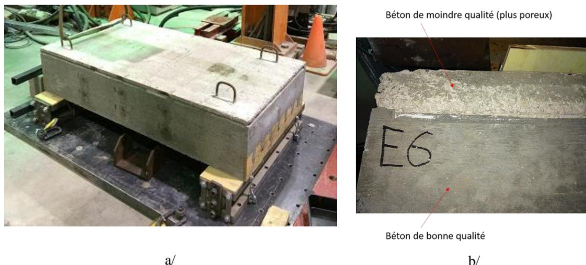
Figure IV.71 : a/ Éprouvette E2 ; b/ La vue en zoom d'une partie de l'éprouvette E6 pour montrer la couche en béton poreux de cette éprouvette.
