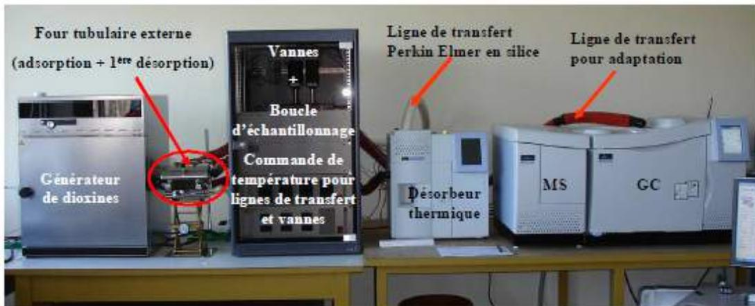
Figure 71 : Dispositif de laboratoire pour l'étude de l'adsorption en phase gazeuse : Générateur de dioxines en phase gaz ; Etage d'adsorption en ligne ; Thermo-désorbeur couplé à un chromatographe en phase gaz et un spectromètre de masse
