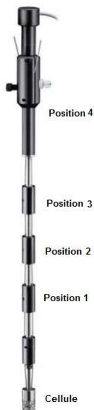
Figure 52 : Schéma de la tige et cellule de mesure
