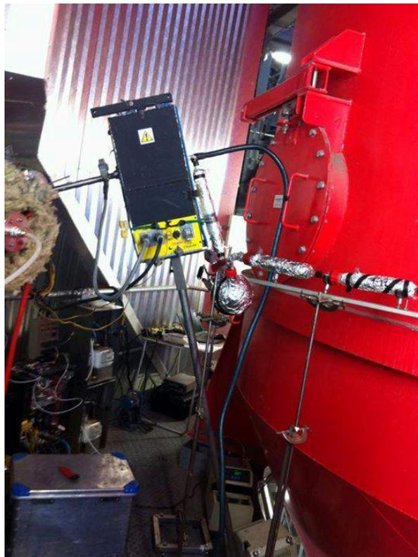
**Figure 78 : Choix du point de prélèvement et installation du train de prélèvement**
