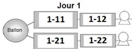
**Figure 76 : Montage utilisé pour le premier jour de la campagne. Les deux cartouches en amont contiennent deux adsorbants testés différents, les deux suivantes contiennent dans tous les cas de la résine XAD-2 pour la mesure de la percée.**
