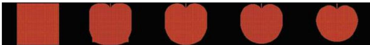
Figure 3.74 Les solutions ESO d'un objet suspendu dans l'air sous son propre poids
