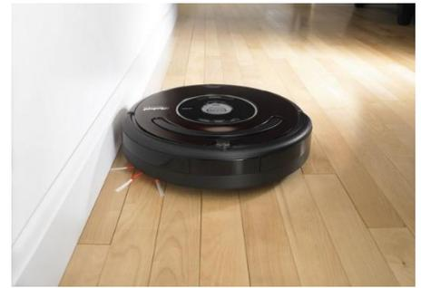
Figure 2.13 Un aspirateur robotique
