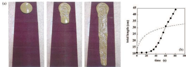
Figure 3.2: **(a)** Expérience d'écoulement d'un fluide à seuil sur une pente. **(b)** Longueur de l'écoulement en fonction du temps et comparaison (cercle) avec le modèle pour lequel la viscosité varie de façon continue au voisinage de  $\sigma_y$  [77]
