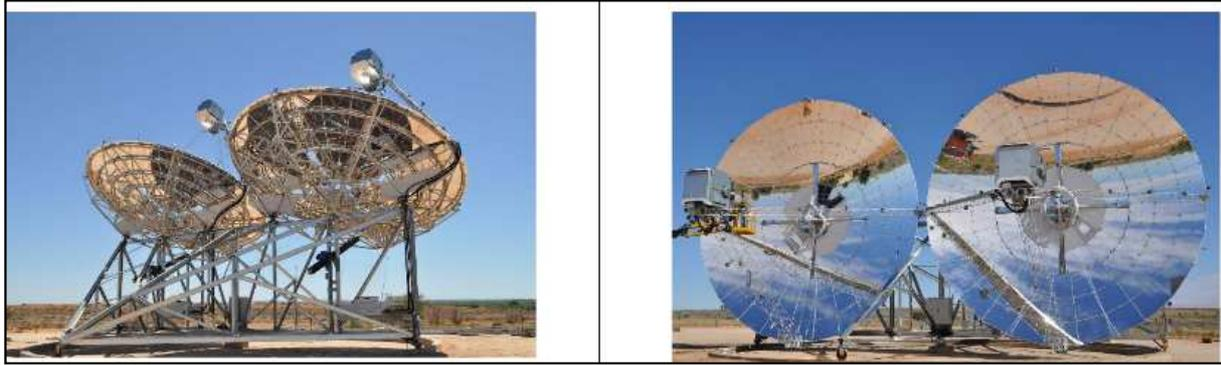
**Fig. 19.** Modules parabole-moteur Stirling de 30 kW construits par RIPASSO Energy. A gauche, fonctionnement, lors de l'obtention du record mondial de conversion d'énergie solaire en électricité à Upington (Afrique du Sud) en janvier 2013. A droite, des techniciens vérifient les machines.
