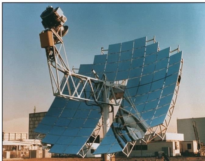
**Fig. 18.** Système Dish/Stirling 4-95 Mark II de 25 kW pour une irradiation de  $1000\text{W}/\text{m}^2$  construit par McDonnell Douglas installé dans la Californie du Sud.
