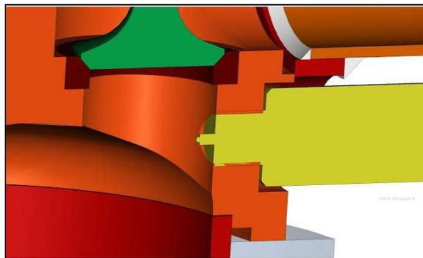
**Fig. 117.** Position du capteur de température (jaune) dans le cylindre de détente près de la soupape d'admission (verte).
