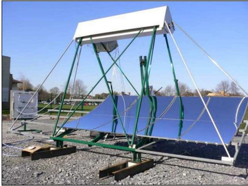
**Fig. 35.** Banc d'essai du capteur solaire cylindre parabolique-vapeur construit au LaTEP.
