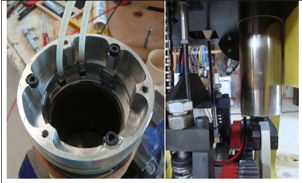
**Fig. 109.** Circulation d'eau dans la partie inférieure de la chemise et dans la tige du piston.
