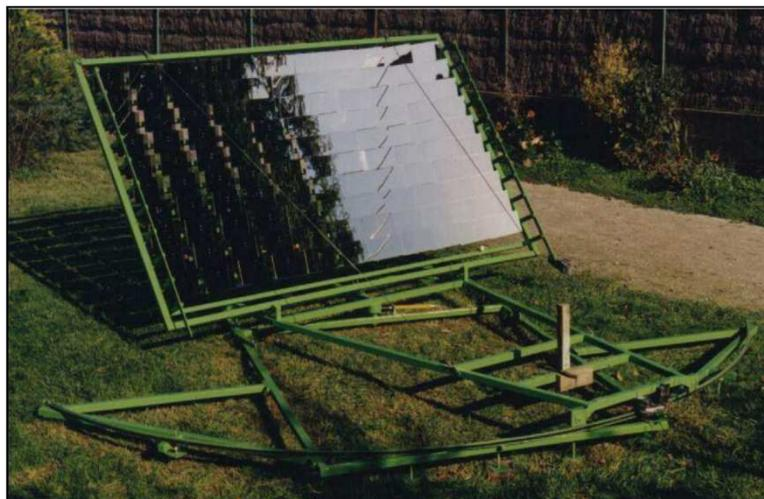
**Fig. 38.** Héliostat d'environ 4kW pour un moteur Stirling construit par Luc Dando.
