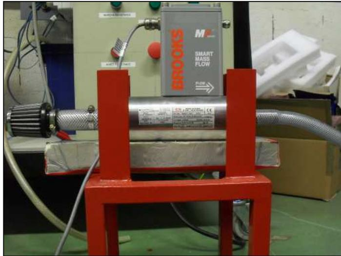
**Fig. 111.** Filtre à air et débitmètre massique à l'aspiration du cylindre de compression.
