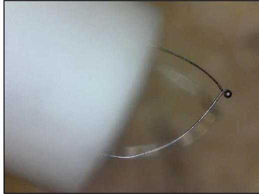
**Fig. 123.**Photo de la jonction des fils de  $12.5 \mu\text{m}$  du même capteur.
