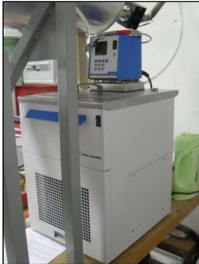
**Fig. 113.** Centrale de réfrigération de l'eau de refroidissement des parois du cylindre de compression et de la tige du piston.
