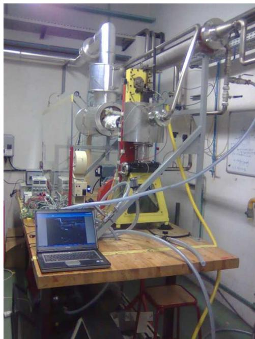
**Fig. 103.** Le prototype de moteur Ericsson.
