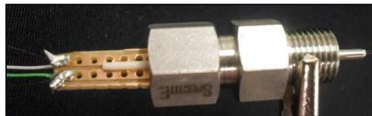
**Fig. 120.** Capteur à  $\mu$ TC assemblé, avant insertion.
