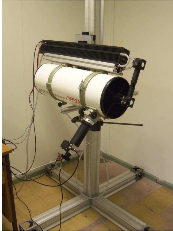
Figure 2.25 : Cliché de l'appareillage utilisant un télescope de Newton
