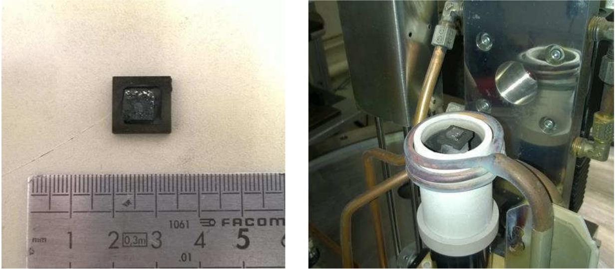
Figure 3.26 : Cliché de l'échantillon (à gauche) et cliché de l'installation dans l'inducteur de la cuve (à droite) au laboratoire
