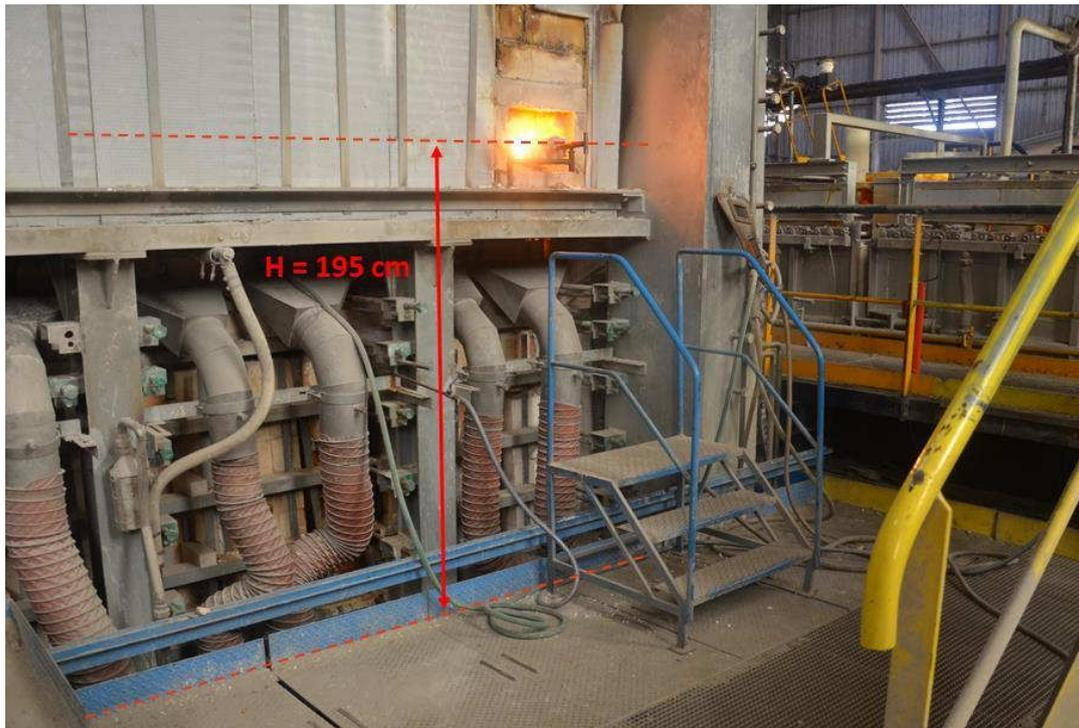
Figure 4.10 : Cliché du hublot de mesure depuis l'extérieur du four
