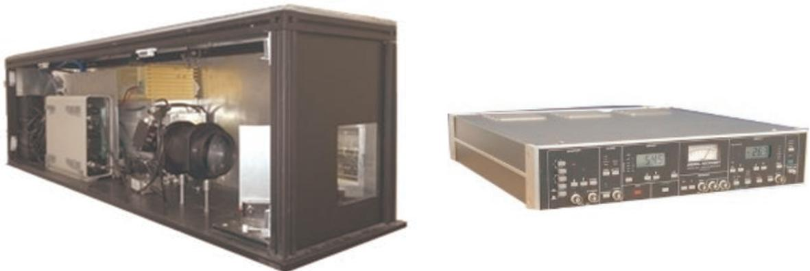
Figure 4.13 : Clichés de l'appareillage intégré dans son caisson de protection (à gauche) et de la détection synchrone analogique utilisée (à droite)
