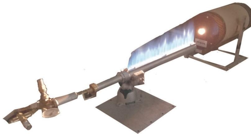
Figure 2.53 : Flamme réalisée devant le corps noir
