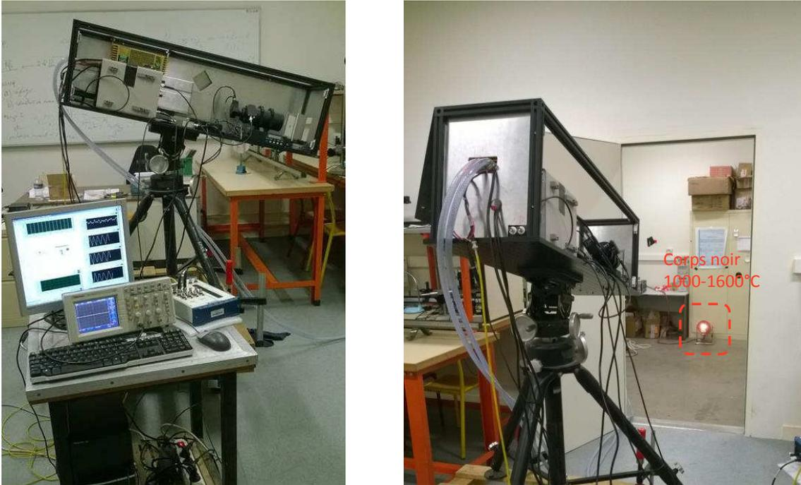
Figure 2.42 : Clichés de l'appareillage en étalonnage à distance sur un corps noir
