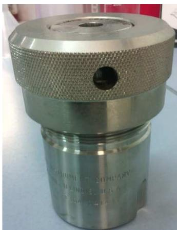
Figure 12 : Photographie d'une bombe PARR utilisée pour la synthèse des polymères.
