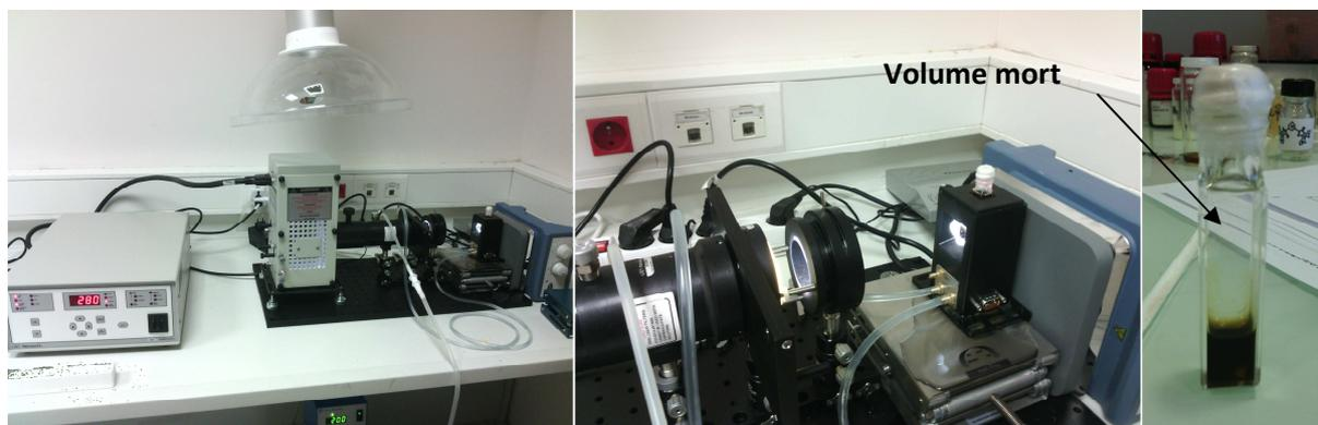
**Figure 1 : Photographies du banc optique (à gauche) et de la cuve en quartz et de la seringue de prélèvement (à droite) servant aux expériences de photo-catalyse.**
