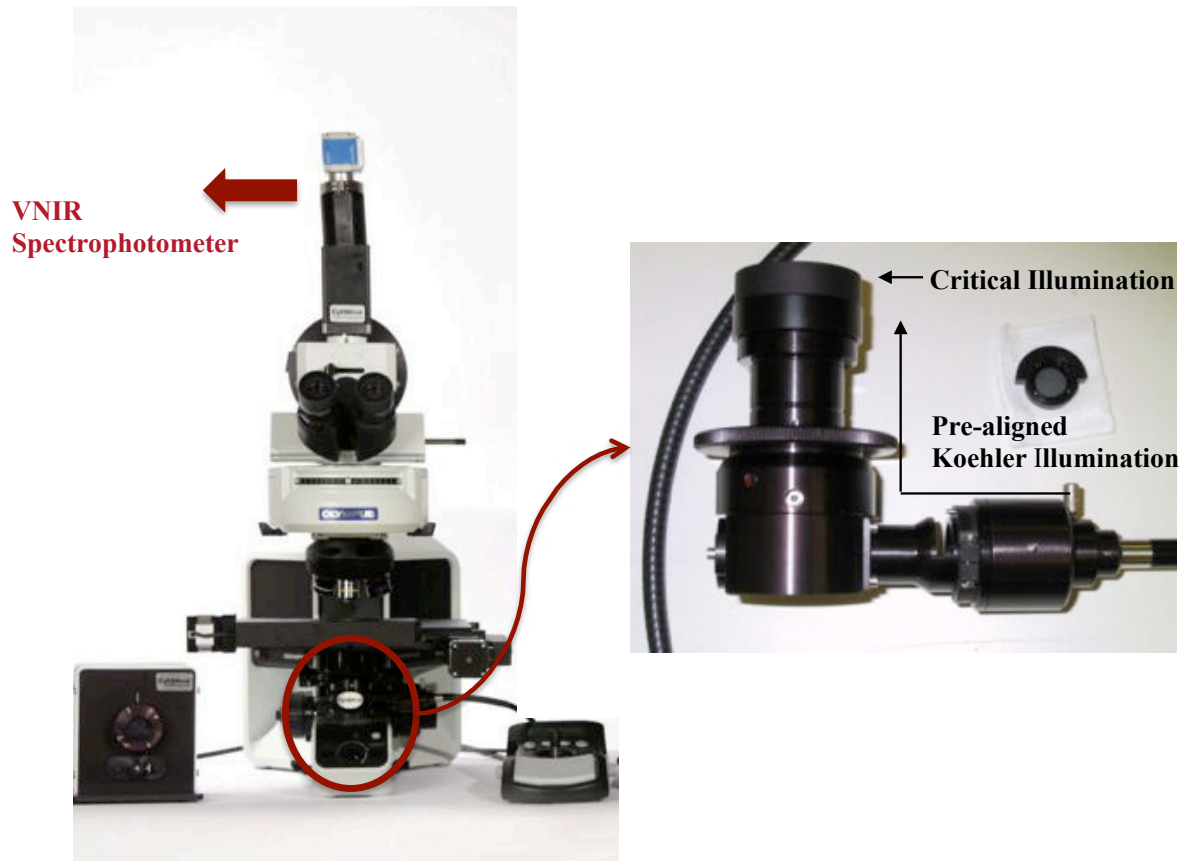
Figure 11 : Microscope confocal à champ sombre (à gauche) équipé d'un spectrophotomètre pour la détection du signal hyperspectral. L'alignement du condenseur (à droite) permet l'amélioration du contraste des images.
