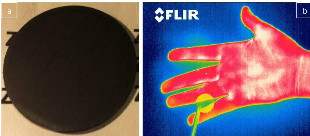
Figure IV-17 Photographie d'une céramique ZnS préparée par frittage HP d'une poudre précipitée (a) et Image IR au travers de celle-ci (b)
