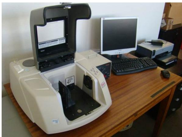
Figure II-16 Spectromètre infrarouge Nicolet 380 FT-IR avec dispositif de mesure en transmission
