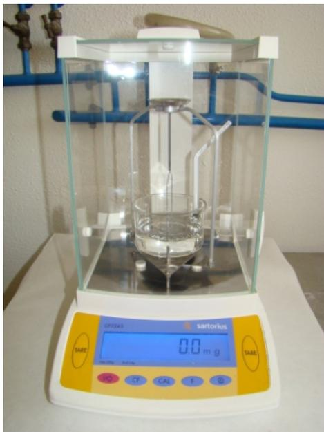
Figure II-14 Balance équipée d'un système de pesée hydrostatique
