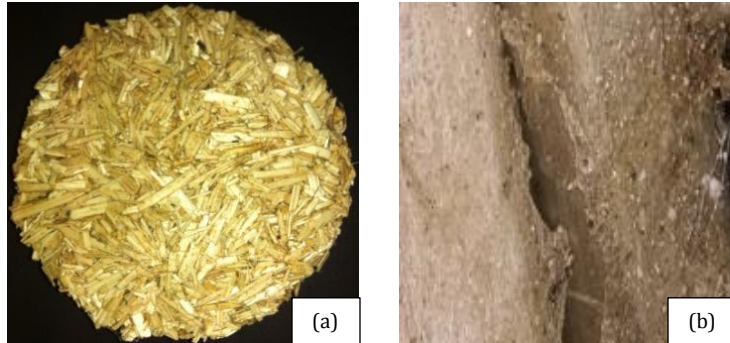
Figure 2 : (a) Image macroscopique d'un échantillon chanvre-amidon, (b) Gross. x 200 chènevottes liées entre elles par le liant d'amidon de blé.
