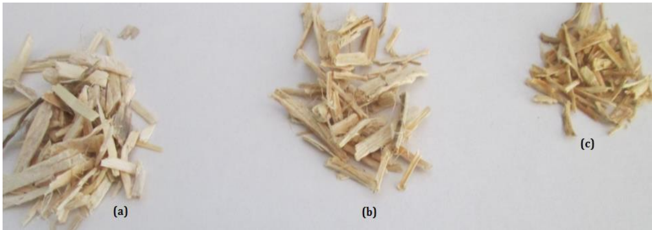
Figure 5 : Influence du traitement NaOH sur les fibres : (a) brutes, (b) 1 % NaOH et (c) 6 % NaOH.
