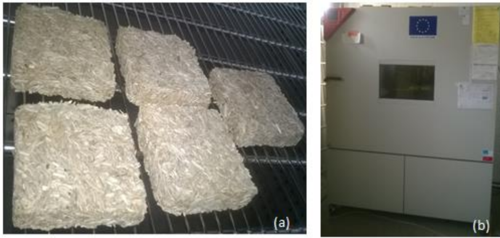
Figure 2: (a) Photographie des échantillons, (b) Enceinte climatique Binder MKF 720.
