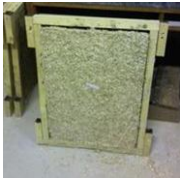
Figure 12 : Panneau en chanvre-amidon dont le rapport massique A/C = 0,31.
