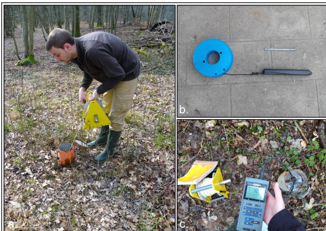
Figure 8-3 : Relevé piézométrique (a), collecteur d'eau (b) et sonde multiparamètres (c).
