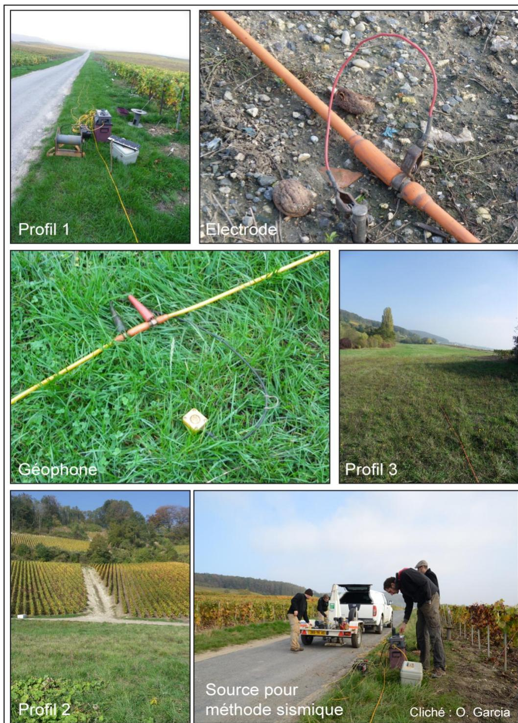
Figure 5-7 : Appareillage géophysique sur le glissement des Jacotines.
