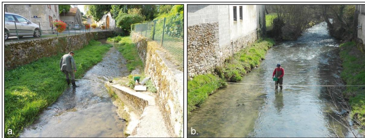
Figure 7-6 : Installation d'une section à Villers-Agron-Aiguizy (a) et jaugeage à Verneuil (b), bassin versant de la Semoigne.
