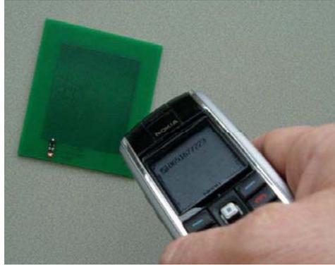
FIGURE 1.20 – Rectenna alimentant une LED, le téléphone GSM (1800 MHz) émettant à une puissance crête d'1 W (d'après [75])
