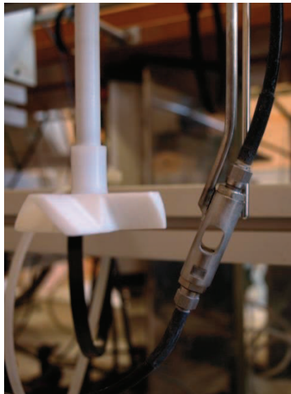
Figure 34 : Photographie de la sonde de turbidité, telle qu'installée dans le réacteur
