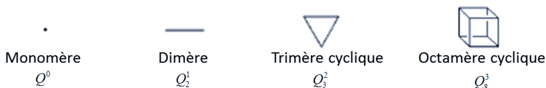
Figure 8 : Exemples de structures polysilicates détectées par RMN du silicium 29 (le numéro en indice correspond au nombre d'atomes de silicium de l'espèce)
