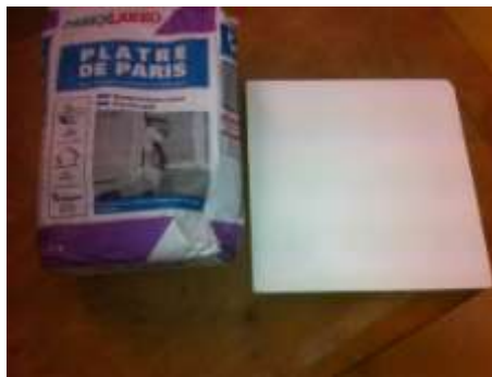
Figure 57: Plâtre et plaque de plâtre testée
