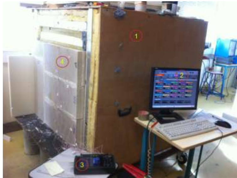
(1) Caisson isolé (3) Centrale d'acquisition GL820 (2) PC de contrôle (4) Paroi testée
