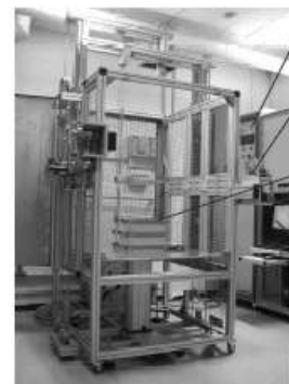
Armoire de puissance et de régulation Système de levage des plaques Plaque chauffante Armoire d'acquisition de mesure
