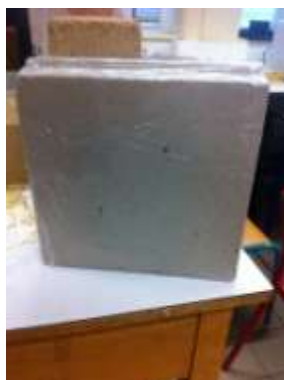
Figure 63: Carreau de béton cellulaire enveloppé dans un film étanche pour essais préliminaires.
