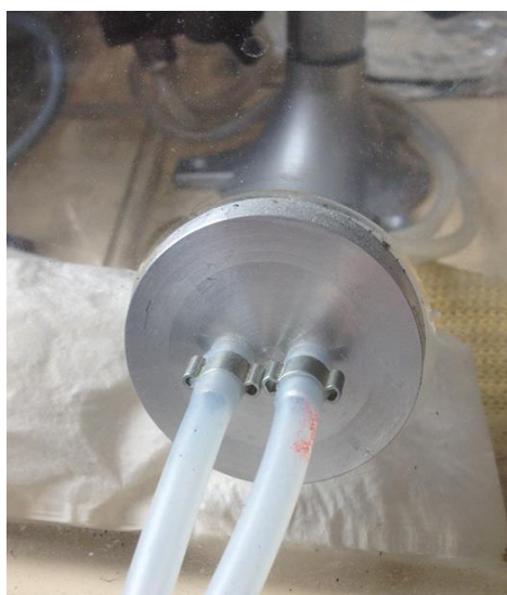
Figure 4.8. Traversée étanche en alliage d'aluminium et tuyaux en Tigon
