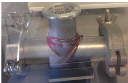
Figure 4.3. T DN25KF pour transfert du tellure entre les BàG. Le T est ouvert pour montrer la position des tubes de tellure.
