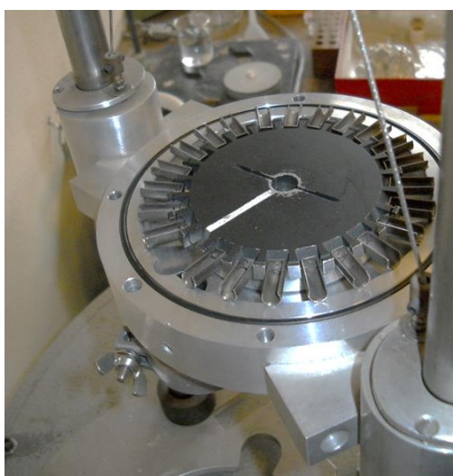
Figure 4.31. Embase de l'introducteur automatique d'échantillons montrant la platine tournante et les 24 nacelles basculantes. Le couvercle de l'introducteur a été démonté pour la photo.
