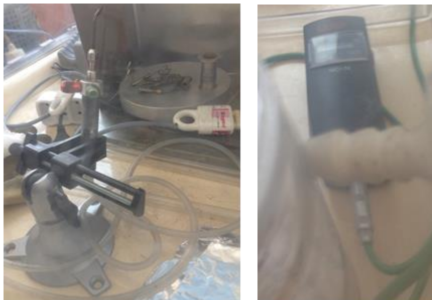
Figure 4.9. Microchalumeau sur son support (à gauche) et thermomètre (à droite) dans la BâG de scellement
