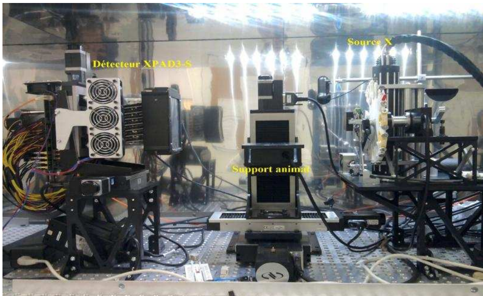
Figure 2.3 : Photographie du PIXSCAN où l'on retrouve de gauche à droite, le bloc détecteur, le bloc animal et le bloc source.
