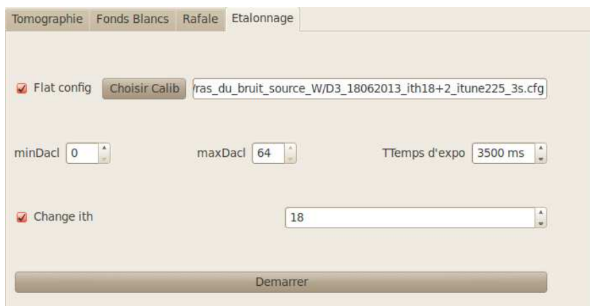
Figure 3.29 : Copie d'écran de l'éditeur d'étalonnage. L'interface est simple, elle permet de définir un fichier de configuration comme point de départ, les paramètres du « ScanDacl », et si l'on souhaite un autre « ITH ». Notons que dans cette configuration, il n'est pas possible d'enchaîner les étalonnages.
