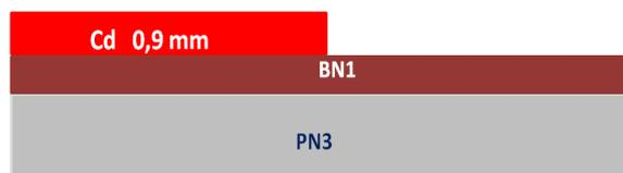
Fig. 5.14: Prototype de dosimètre neutron par exploration des thermiques
