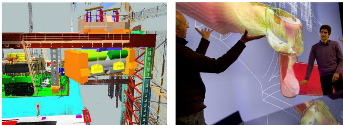
**FIGURE -0.1 – Deux exemples d'études utiles à la maintenance d'une centrale électrique utilisant des données géométriques.** A gauche : simulation de l'extraction d'un gros composant. A droite : simulation d'un phénomène physique interne de l'un des composants de l'installation.
