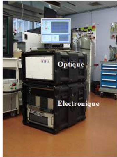
FIGURE 3.7 – Photo de l'instrument QCLAS. Instrument compact composé de deux principaux ensembles : un ensemble contenant de montage optique (bloc supérieur) et un ensemble contenant toute l'électronique (bloc inférieur)
