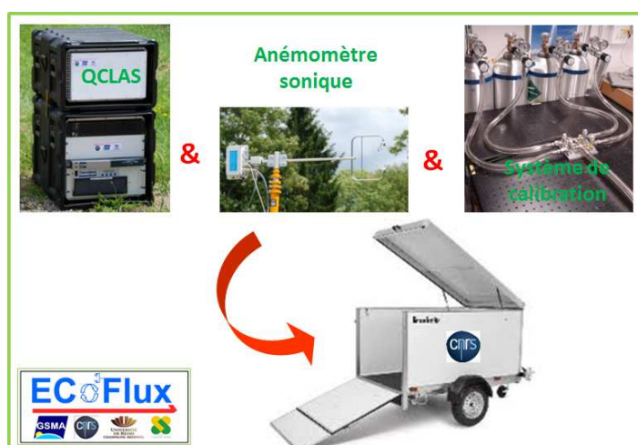
FIGURE 8.1 – Composants de la station mobile ECoFlux à savoir : le QCLAS , un système de calibration, et un anémomètre sonique tous intégrés dans une remorque permettant de transporter l'ensemble
