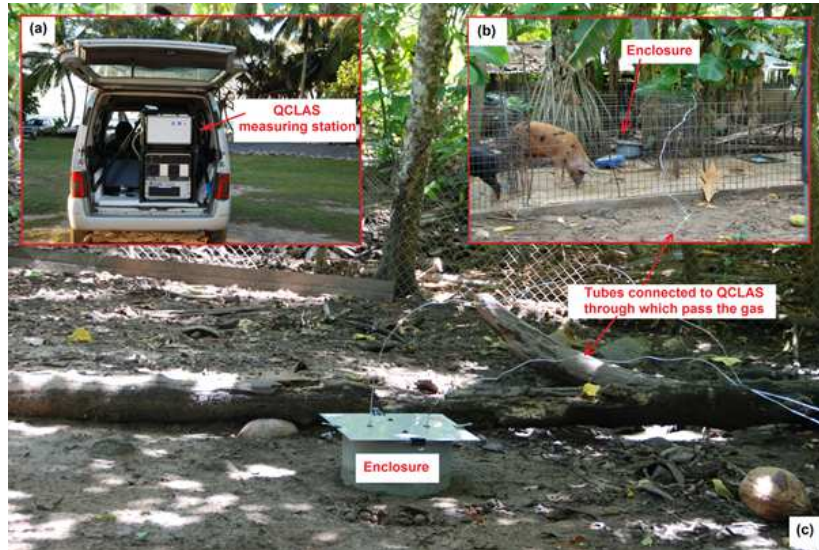
FIGURE 7.12 – Quelques images de la campagne de mesures ((a) installation de QCLAS pour les mesures, (b) et (c) mesure en cours dans la localisation ZI1 de SL1 et SL2 respectivement)
