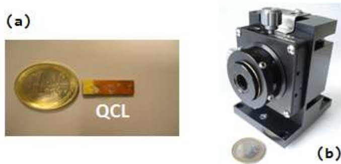
FIGURE 3.10 – (a) Une diode laser à cascade quantique, (b) boîtier contenant la diode laser QCL, intégré à QCLAS
