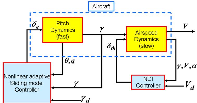
FIGURE 5.1 – Structure proposée pour la commande du vol
