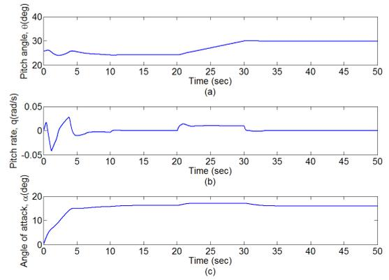
FIGURE 5.3 – Évolution de l’angle de tangage (a), vitesse de tangage (b) et l’angle d’attaque (c).
