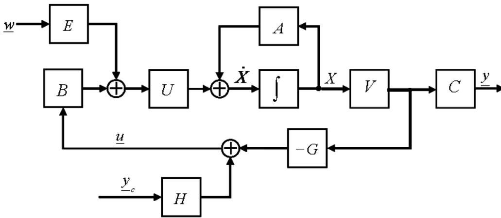
FIGURE 3.2 – Représentation structurelle du système commandé
