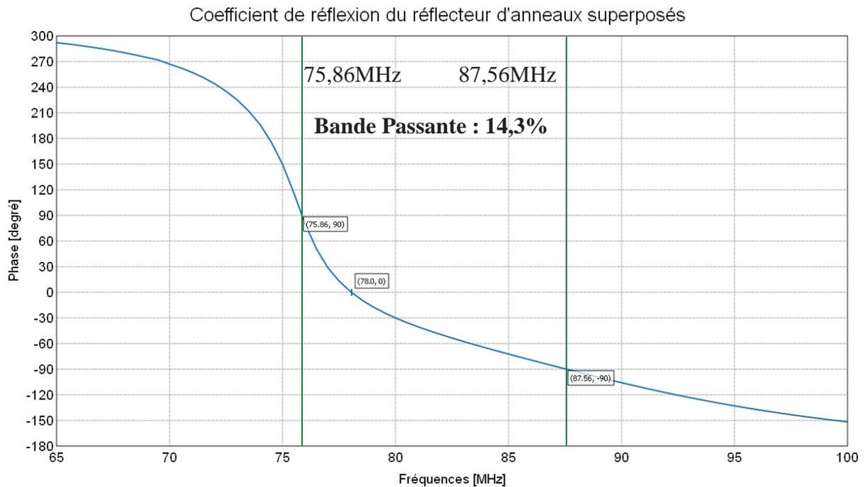
Figure 88 : Phase du coefficient de réflexion des 5 anneaux sans spirale
