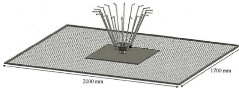
Figure 12 : Exemple 2 d'antenne disque-conique [100 ; 500MHz].
