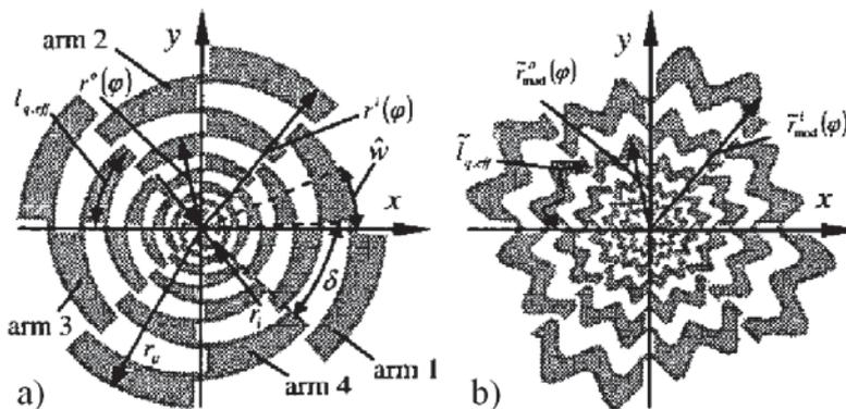
Figure 24 : Antennes sinueuse miniaturisée par des ondulations sur les brins.
