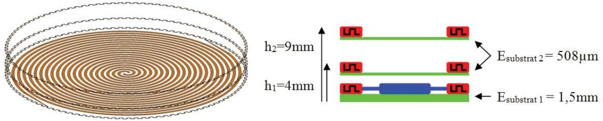
Figure 96 : Maquette n°4/6 : Spirale d'Archimède + 3 anneaux crénelés (nombre de créneaux  $N_c=100$ ),
