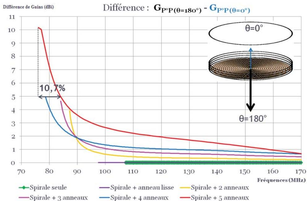
Figure 92 : Différence entre le gain dans l'axe (polarisation principale) pour  $\theta=0^\circ$  et pour  $\theta=180^\circ$ , pour l'antenne spirale seule et l'antenne spirale à 5 anneaux, Ø1m sans substrat
