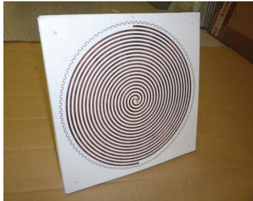
**Figure 137 : Antenne spirale miniaturisée par la méthode de réduction des anneaux résonnants. Substrat papier. Diamètre 28cm, 3 anneaux crénelés à 100 motifs. Travaux réalisés par Jérémy Valleau.**
