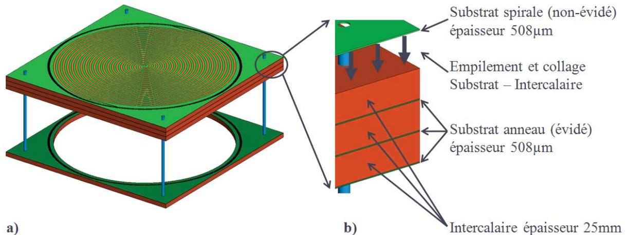
Figure 138 : Schéma de l'antenne à 5 anneaux (Ø1m), a) vue globale, b) détail
