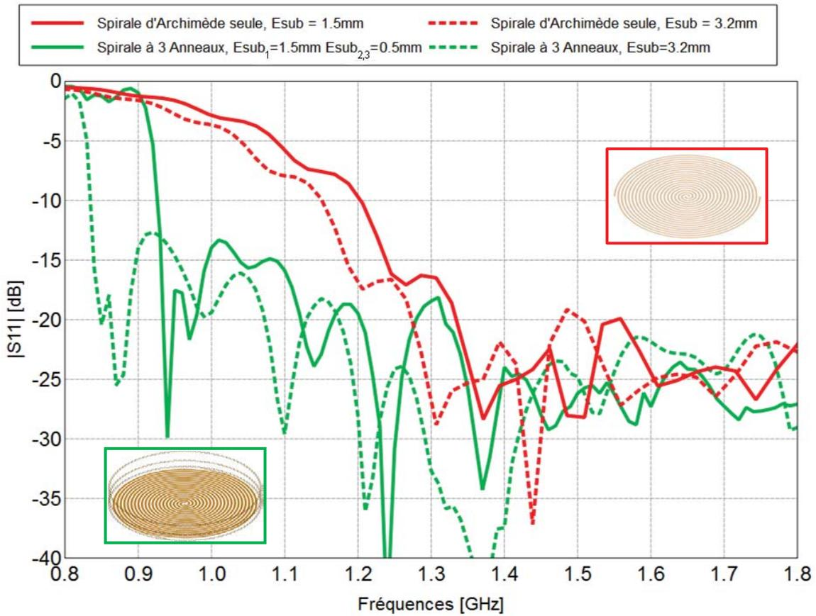
Figure 100 : Influence de l'épaisseur du substrat sur le coefficient de réflexion des antennes spirales
