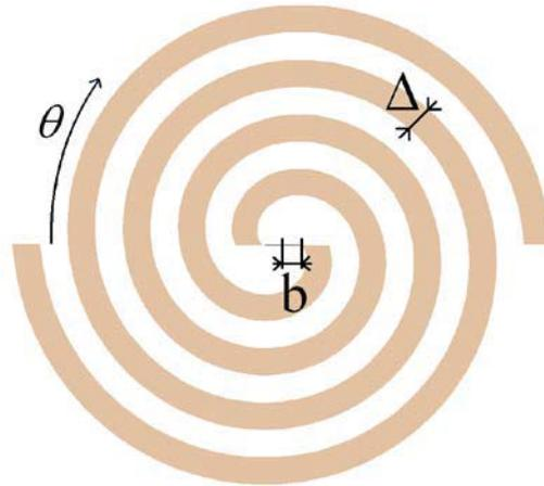
Figure 4 : Antenne spirale d'Archimède à deux brins
