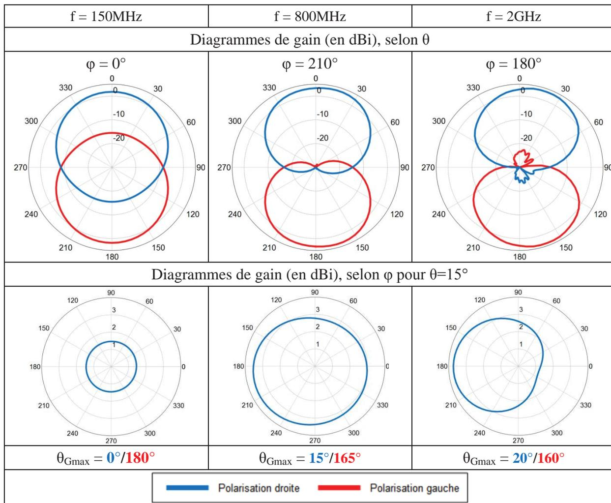
Figure 87 : Diagramme de gain de l'antenne spirale avec déphasage à l'excitation différent de  $\pi$ , pour les fréquences 150MHz, 800MHz et 2GHz, dans les plans  $\theta$  tels que le gain est maximal, puis pour  $\varphi=15^\circ$ .
