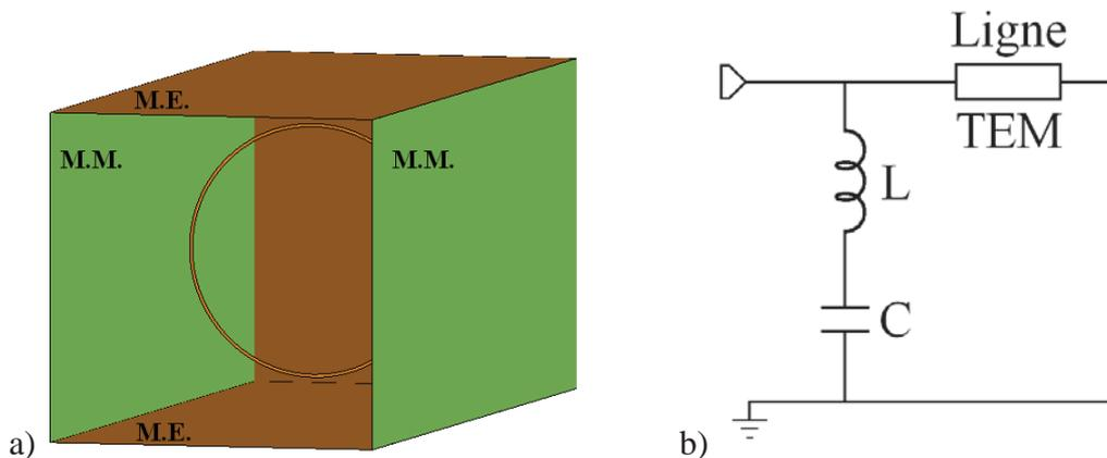
Figure 65 : a) Schéma d'un anneau métallique dans un guide court-circuité, avec deux murs électriques et deux murs magnétiques, b) Schéma équivalent de cet anneau
