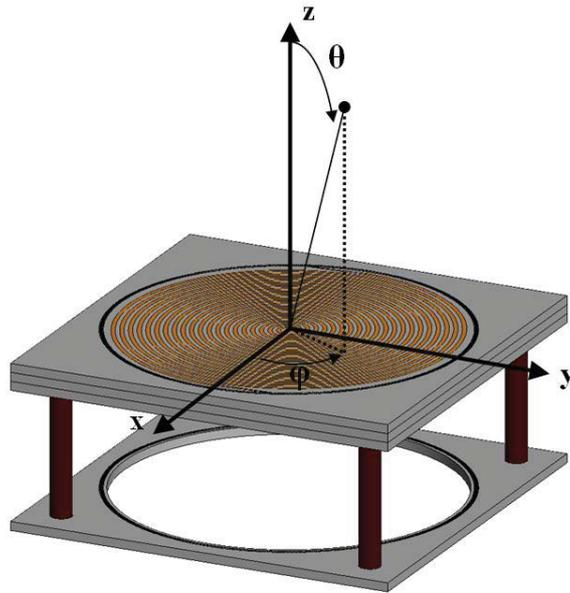
Figure 141 : Repère de l'antenne spirale VHF
