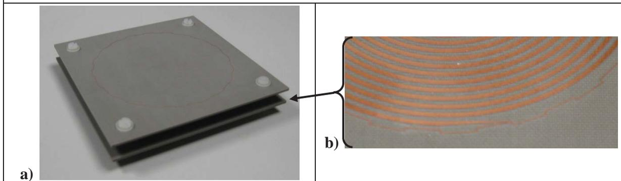
Figure 107 : Photographies de la maquette 3 : Spirale d'Archimède + 2 anneaux crénelés (N=20) ; a) empilement des deux couches, b) gros plan de la connexion spirale – anneau à 20 créneaux.
