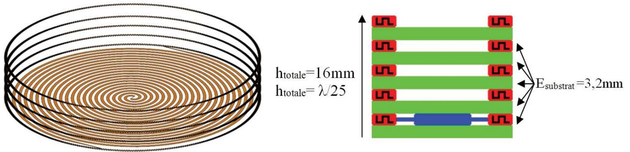
Figure 102 : Maquette n°6/6 : Spirale d'Archimède + 5 anneaux crénelés (nombre de créneaux  $N_c=340$ ),
