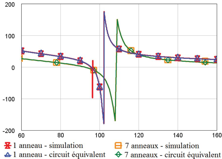
Figure 66 : Phase du  $S_{11}$  du guide court-circuité et chargé par un anneau - Configurations 1 et 7 anneau(x) – obtenue à partir des simulations électromagnétiques et du circuit électrique équivalent
