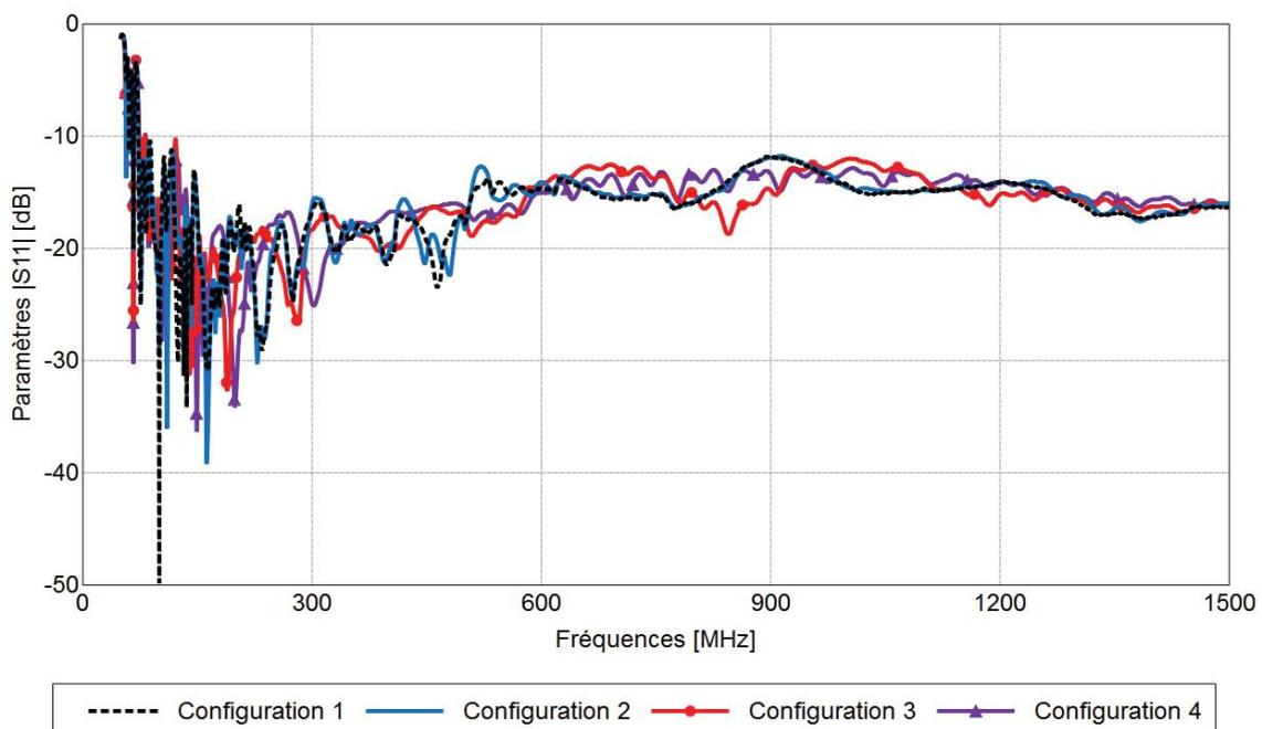
Figure 153 : Coefficient de réflexion en entrée de l'antenne VHF sur [50MHz ; 1,5GHz], Mesures en configurations n°1,2,3&4, H=32cm
