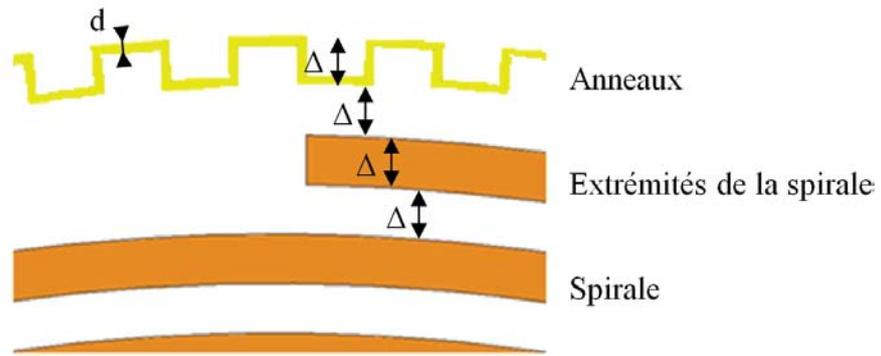
Figure 36 : Anneau crénelé entourant la spirale.
