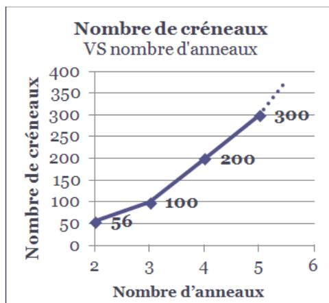
Figure 73 : Nombre de créneaux par anneau d'une antenne Ø1m sans substrat en fonction du nombre d'anneaux
