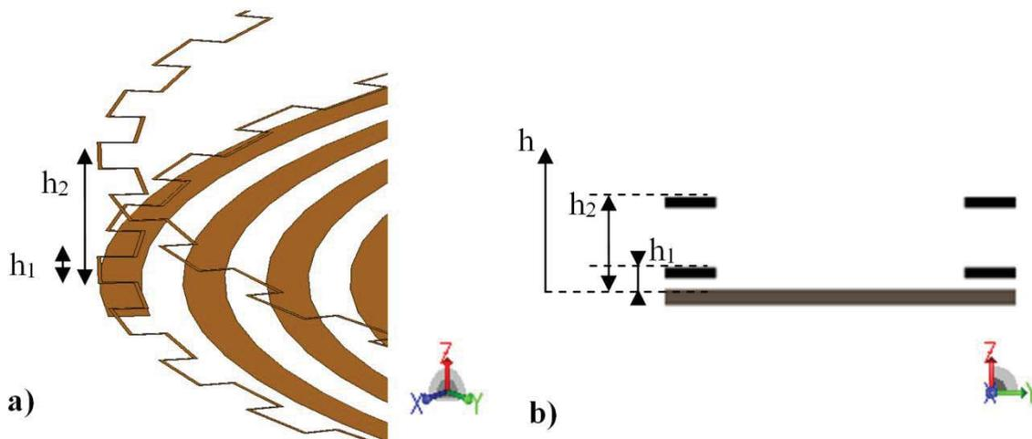
Figure 50 : Antenne spirale et deux anneaux crénelés placés au-dessus. a) vue oblique, b) vue en coupe
