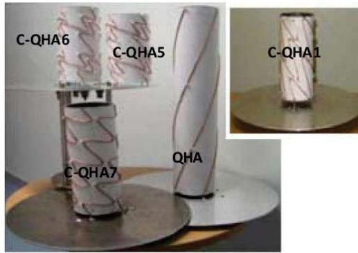
Figure 21 : Antenne hélice quadrifilaire miniaturisée
