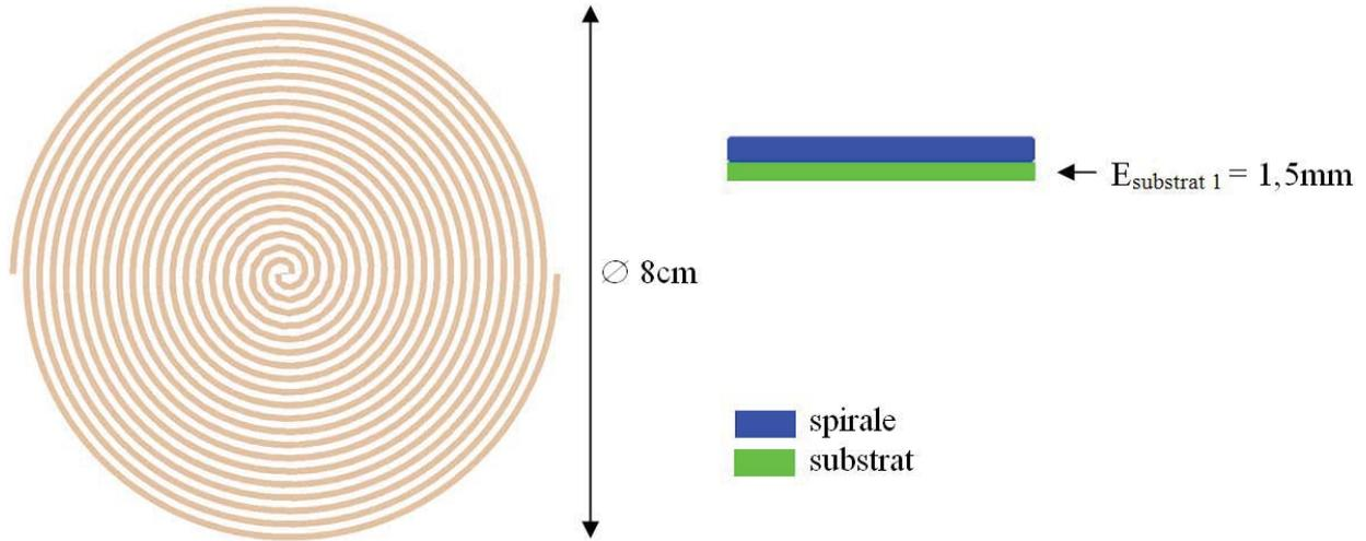
Figure 93 : Maquette n°1/6 : Spirale d'Archimède, a) vue de dessus, b) vue en coupe
