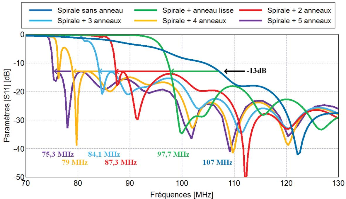
Figure 78 : Coefficient de réflexion en entrée des antennes spirales ( $\text{Ø}1\text{m}$ ) + 0 à 5 anneau(x) sans substrat
