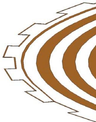
Figure 38 : Antenne spirale d'Archimède et anneau crénelé connecté dans son plan.
