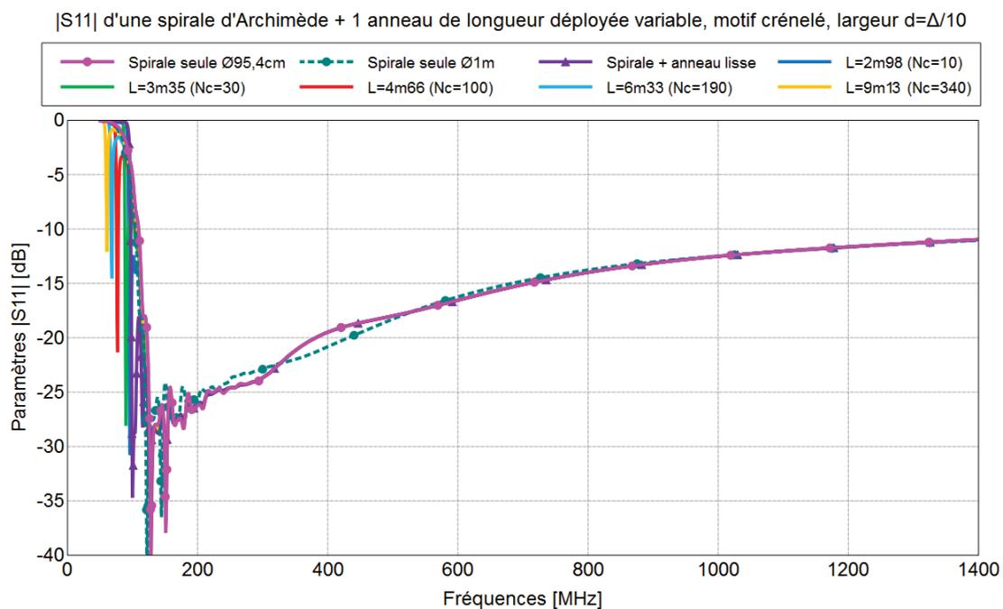
Figure 42 : Coefficient de réflexion |S<sub>11</sub>| en entrée d'une spirale d'Archimède entourée ou non par un anneau pour diverses longueurs déployées, de 50MHz à 1,4GHz
