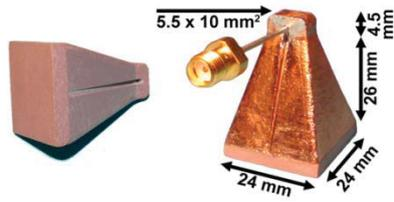
Figure 31 : Cône métallique rempli de céramique
