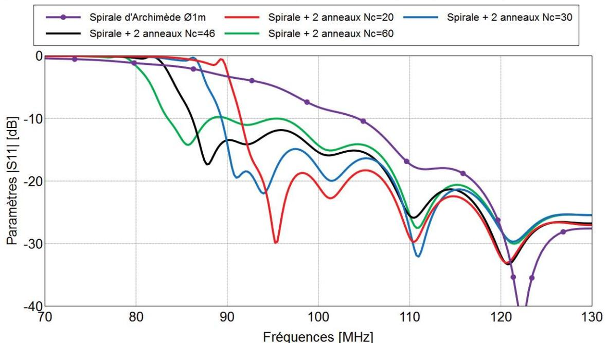
Figure 52 : Coefficient de réflexion  $|S_{11}|$  en entrée d'une antenne spirale d'Archimède ( $\text{Ø}1\text{m}$ ) à deux anneaux crénelés de diverses longueurs ( $N_c=20, 30, 46$  et  $60$ )
