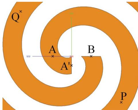
Figure 85 : Illustration de l'excitation de l'antenne avec déphasage différent de  $\pi$  et variable avec la fréquence
