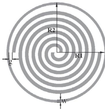
Figure 30 : Spirale d'Archimède entourée par un anneau
