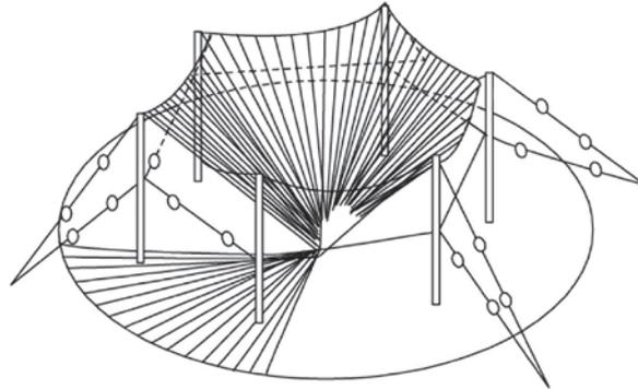
Figure 11 : Exemple 1 d'antenne disque-conique [2 ; 14MHz].
