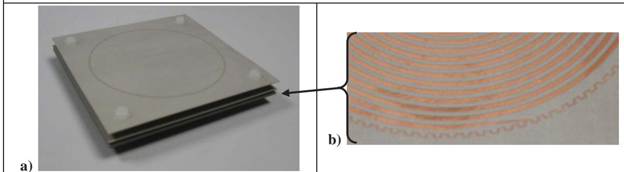
Figure 108 : Photographies de la maquette 4 : Spirale d'Archimède + 3 anneaux crénelés (N=100) ; a) empilement des trois couches, b) gros plan de la connexion spirale – anneau à 100 créneaux.
