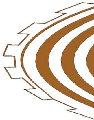
Figure 121 : Antenne spirale d'Archimède et anneau crénelé connecté dans son plan.
