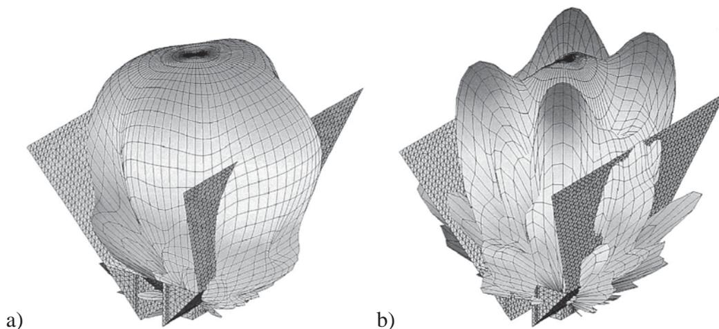
Figure 15 : Directivité du cornet nervuré a) à 10 GHz, et b) à 15GHz
