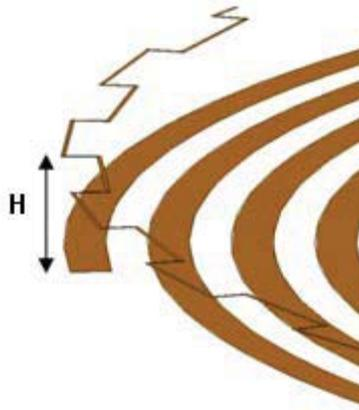
Figure 47 : Antenne spirale d'Archimède superposé d'un anneau crénelé
