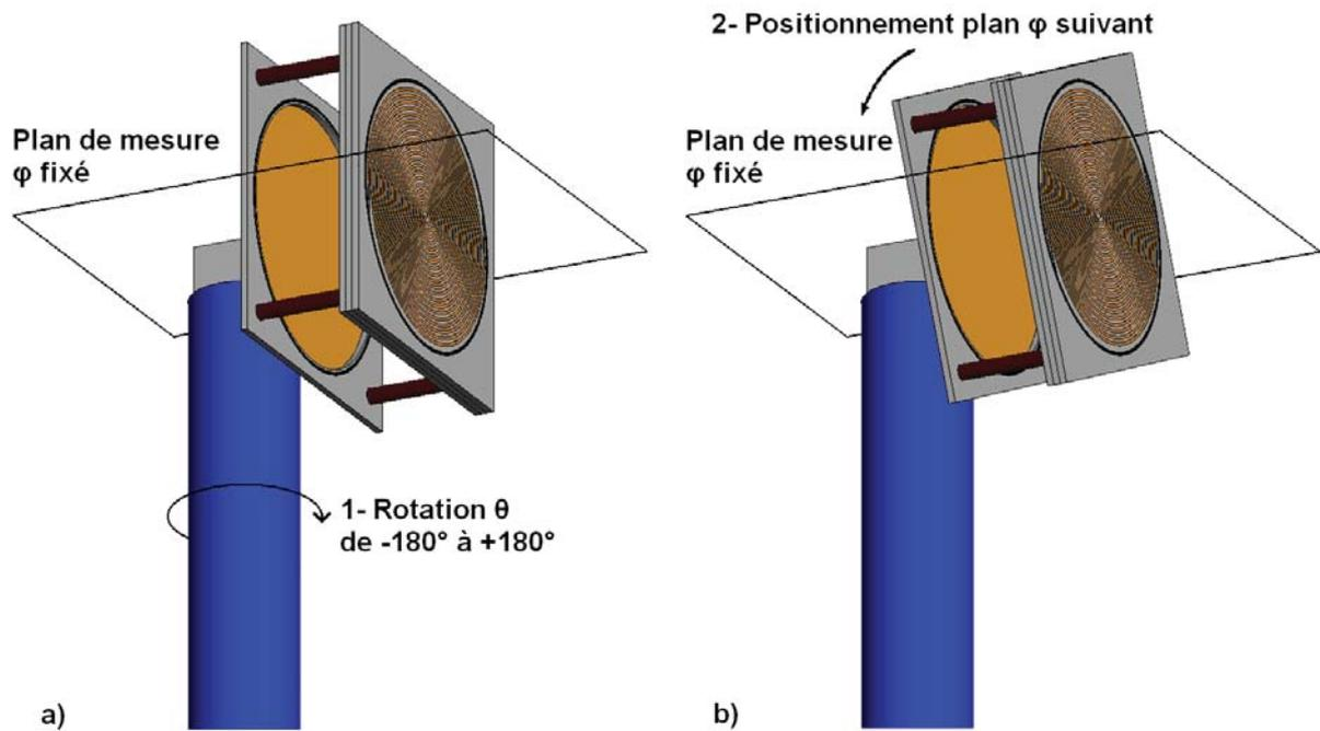
Figure 158 : Illustration de la mesure en champ proche : a) rotation du mât pour  $\theta$  allant de  $-180^\circ$  à  $180^\circ$ , b) rotation de l'axe de la spirale pour  $\phi$  allant de  $0^\circ$  à  $180^\circ$ .
