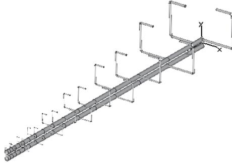
Figure 25 : Antenne log-périodique miniaturisée par pli des dipôles
