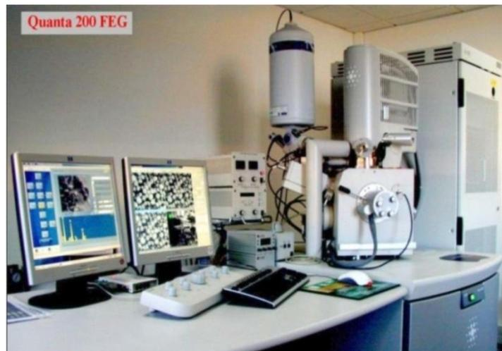
Figure II.38. Microscope électronique à balayage environnemental de l'École des Mines d'Alès
