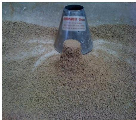
Figure II.29. Moule tronconique et cône de granulats
