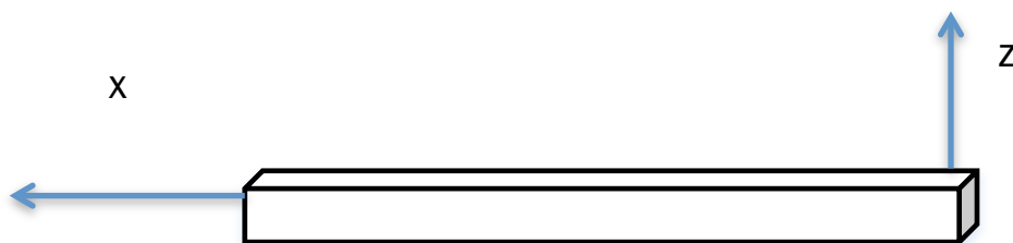
Figure 61 : Schéma des barreaux de traction de dimension 120 mm x 25 mm x 2 mm
