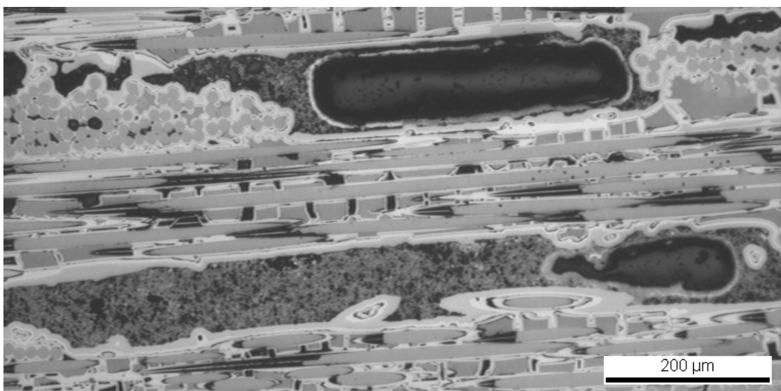
Figure 57 : Image MEB après céramisation d'une résine PMS chargée avec 35%v d'aluminium (pyrolyse effectuée sous diazote à 1100°C)
