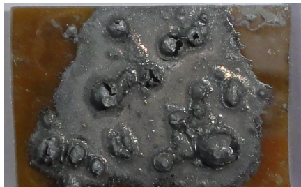
Figure 53 : Wafer de SiC avec un tas de poudres d'aluminium déposé en surface et porté à 900°C pendant 1 heure sous argon.
