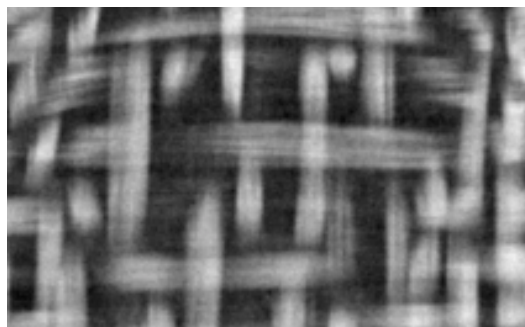
Figure 6 : Micro-Tomographie d'une texture sèche
