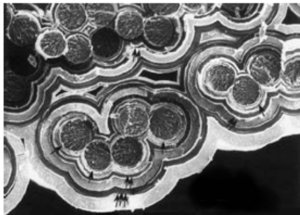
Figure 12 : Micrographie électronique de la section transverse d'un composite unidirectionnel à matrice multiséquencée [37].
