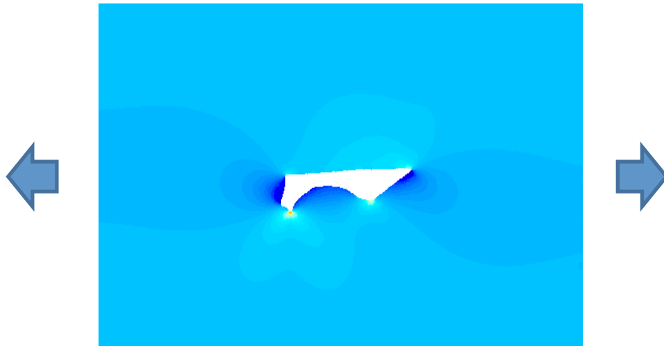
Figure 9 : Simulation de la traction de la plaque 2D contenant le défaut
